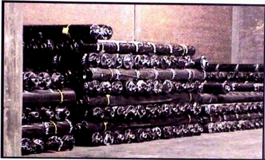
Fig. 1- 8 Almacenamiento de los Geotextiles
