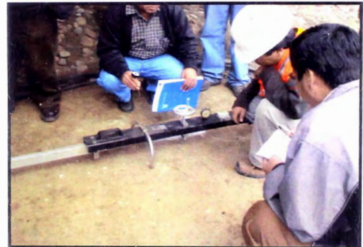
FOTO N° 24 Lecturas con la viga Benkelman
