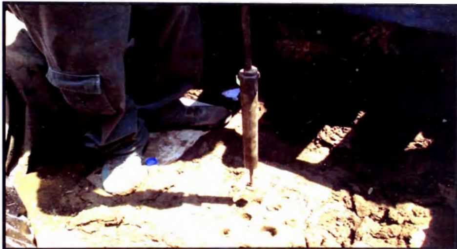
Fig. 11-13 Penetrómetro en la poza experimental
