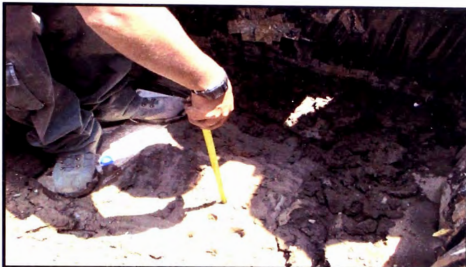
Fig. 11-15 Medida de la oquedad del Penetrómetro
