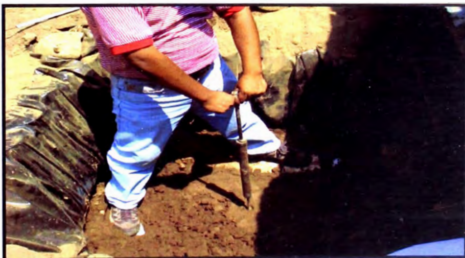
Fig. 11- 14 Prueba de resistencia del suelo con Penetrómetro
