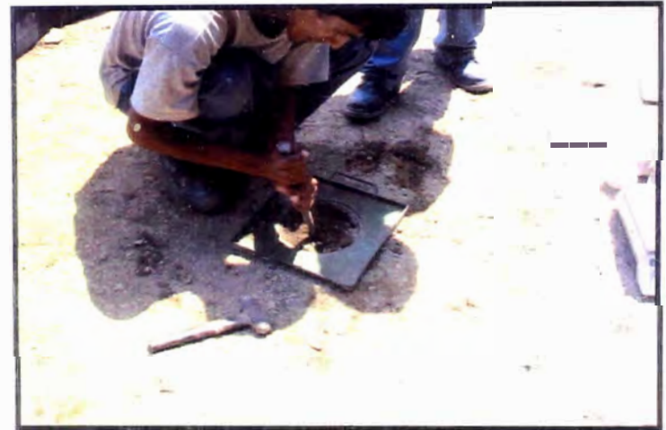
FOTO N° 12 Control de compactación de la primera capa
