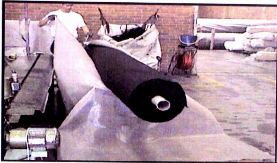
Fig. 1-15 Empacado del Geotextil No Tejido
