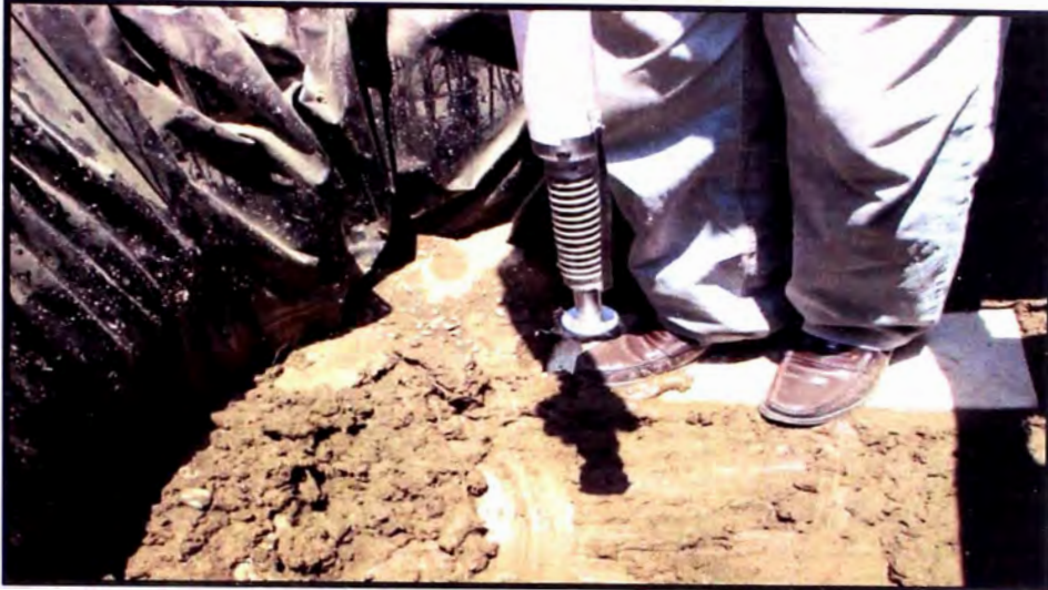
Fig. 11- 12 Penetrómetro en la poza experimental
