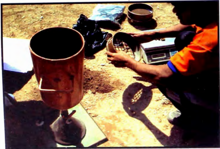
FOTO N° 13 Tamizado del material retenido malla W'
