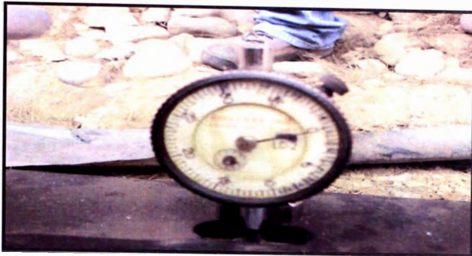
Fig. 11- 36 Vista del Extensómetro de precisión que mide las deformaciones
