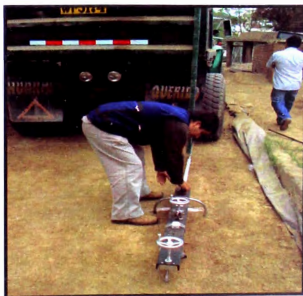
Fig. 11- 35 Puesta en estación viga Benkelman
