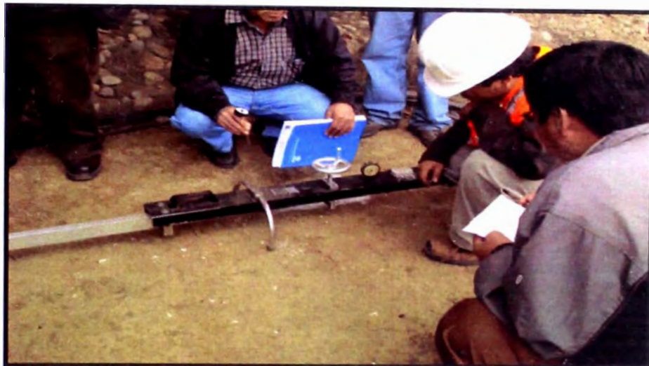
Fig. 11- 37 Medida de las deflexiones en la vía afirmada
