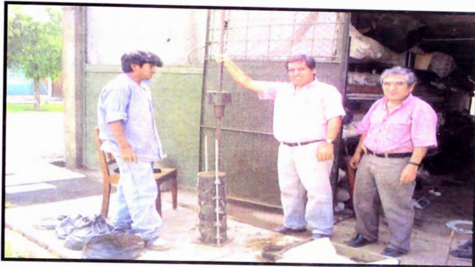
Fig. 11- 16 Ensayo de penetración con equipo OPL
