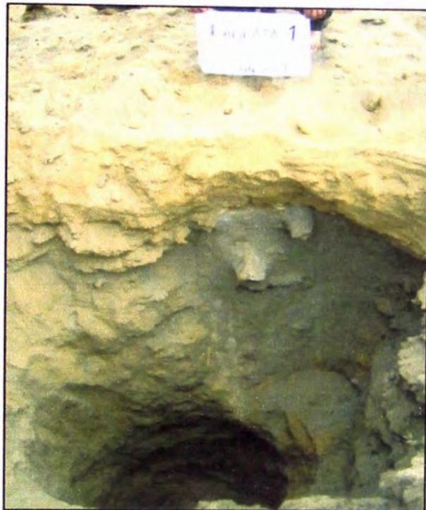
Figura 2.7: Foto de la calicata 1, se observa el material compuesto por arenas con limos.
