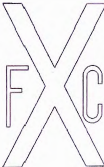
SEÑALIZACIÓN PINTADA EN LA PISTA ANTES DE UN CRUCE A NIVEL
