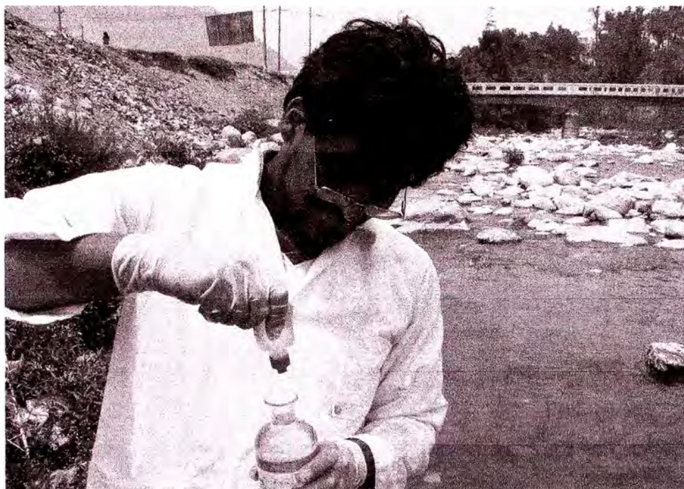
Figura A2.10 Muestreador adicionando los preservantes a las muestras para su conservación en el tiempo
