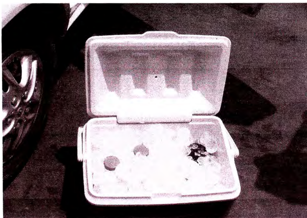
Figura A2.11 Muestras colocadas en el recipiente y preservadas con hielo para su conservación hasta su llegada al laboratorio, para su respectivo análisis
