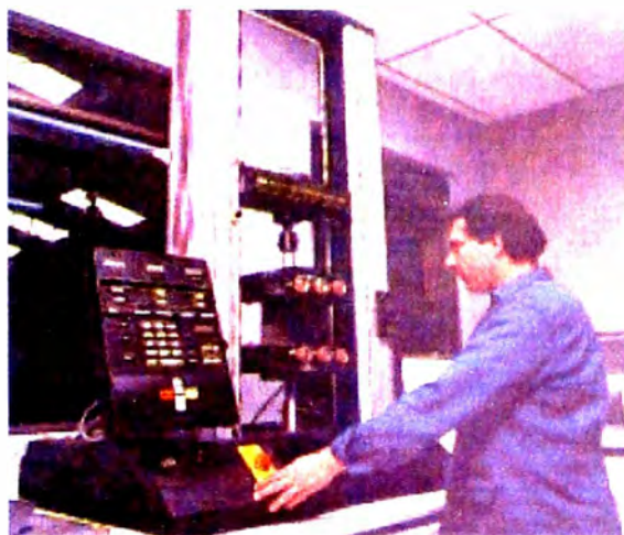
Fig. 1.13 Ensayo de Resistencia a la Tensión por el Método de la Tira Ancha Wide – Width (ASTM D-4595)
