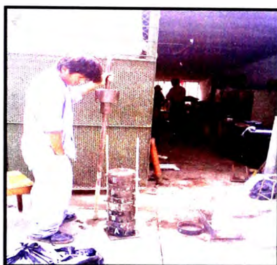
Fig. 2.17 Ensayo penetración DPL en el laboratorio de suelos y geotecnia.
