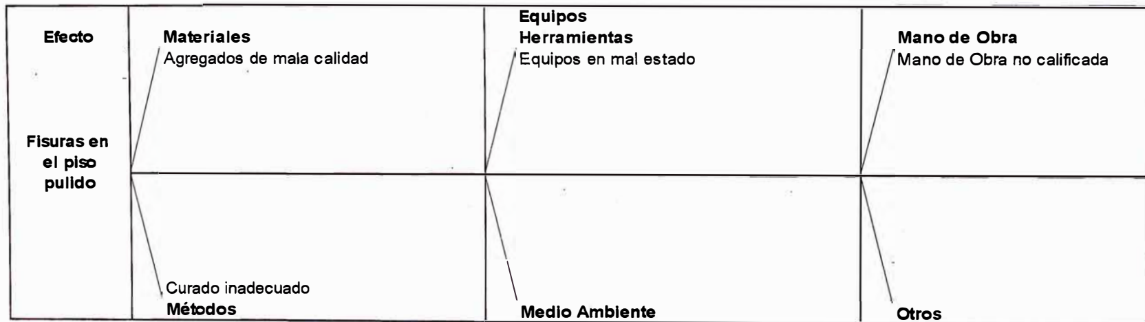
Gráfico N° 2.6 Diagrama Causa - Efecto del problema de mayor frecuencia – piso pulido
