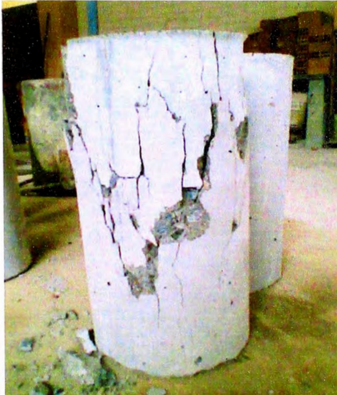
Cilindro después del ensayo a compresión
