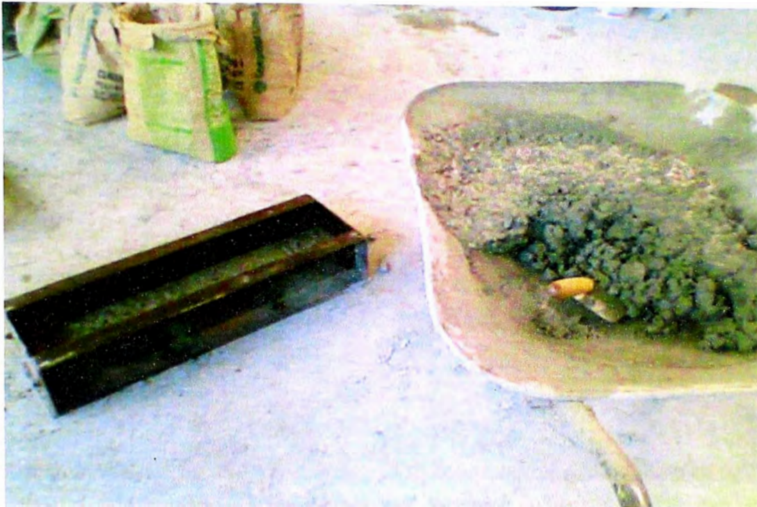
Preparación de vigas de concreto para ensayo a flexión
