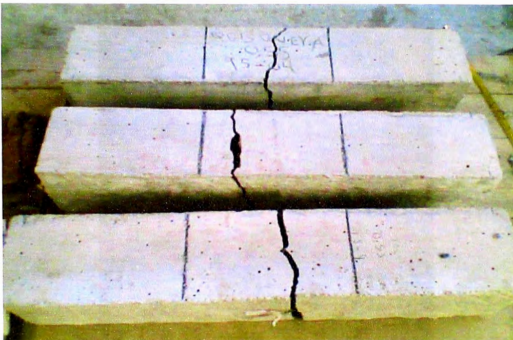
Falla de las vigas en el tercio central
