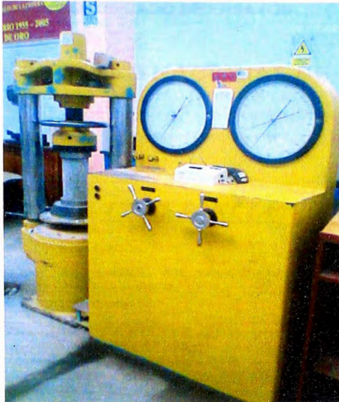
Ensayo de resistencia a la compresión
