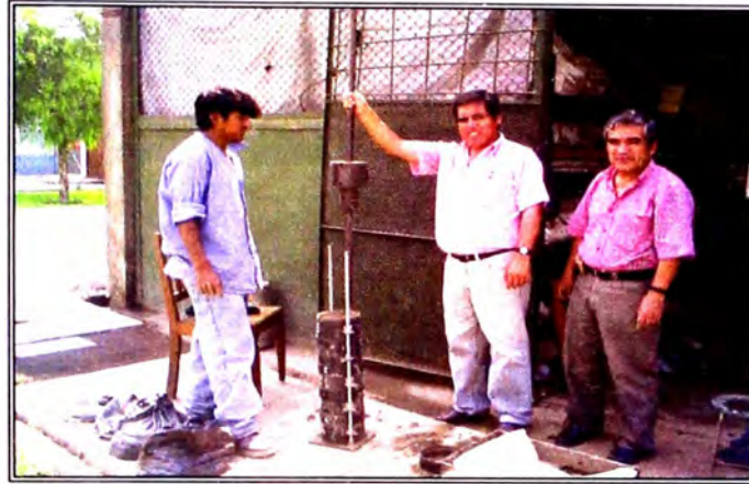
Ensayo de correlación con equipo DPL en el laboratorio de geotecnia
