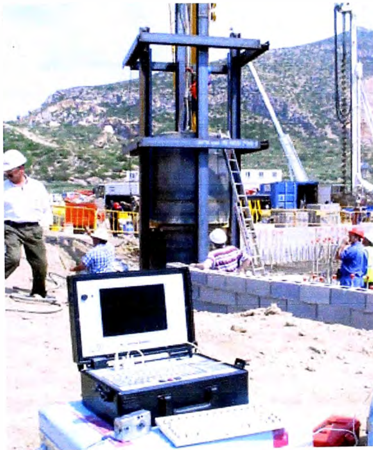
Figura 6.2 Equipo para pruebas de carga dinámica en pilotes excavados
