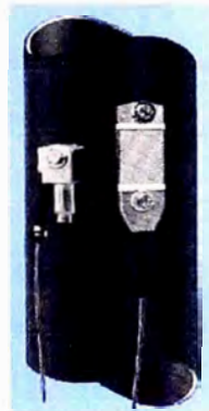
Figura 6.1 Sensores utilizados en una prueba de carga dinámica
