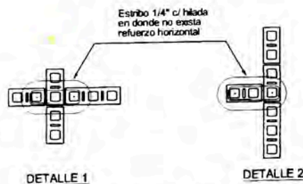
DETALLES TÍPICOS CONECTORES DE CORTE Esc. 1:25
