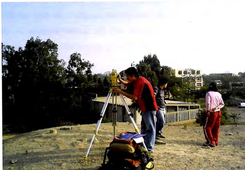
Figura 3.2.- Estación Total utilizado en el Levantamiento Topográfico
