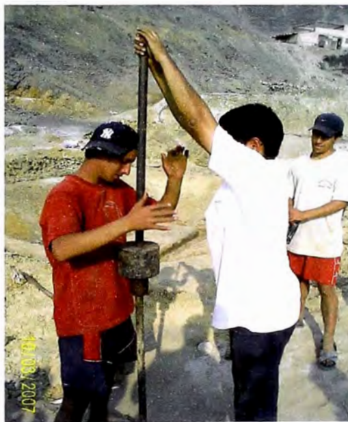
Figura 4.8.- Vista del Ensayo DPL-3 soltando el Martillo.
