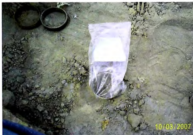
Figura 4.13.- Vista de la Muestra con el Anillo usado para el Calculo de la Densidad de Campo.
