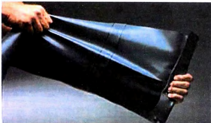
Figura 2.2.- Vista de la lámina delgada de geomembrana
