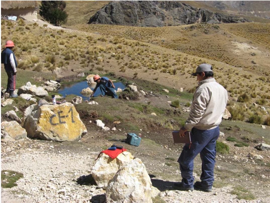
Foto N° 06: Estación de muestreo emplazada en la parte baja del tajo donde se ha tomado la muestra de agua CE - 1 sedimentos CES - 1 en la poza de acumulación de las escorrentías de agua.
