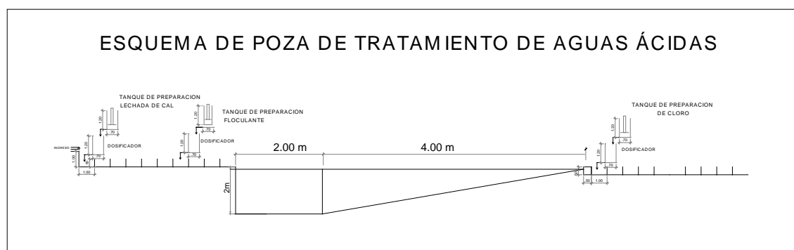
Figura N° 03: Poza de tratamiento de aguas ácidas
