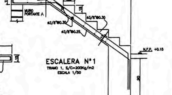
ESCALERA N°1 TRAMO 1, S/C=200Kg/m 2 ESCALA 1/50
