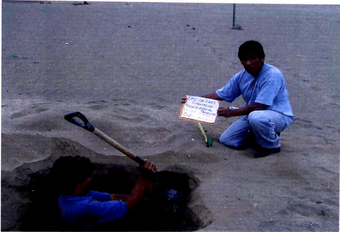
FOTO 2 Vista de la extracción de muestras llevadas al laboratorio, investigación del subsuelo, se observa la capa superficial de caliche de baja compacidad.
