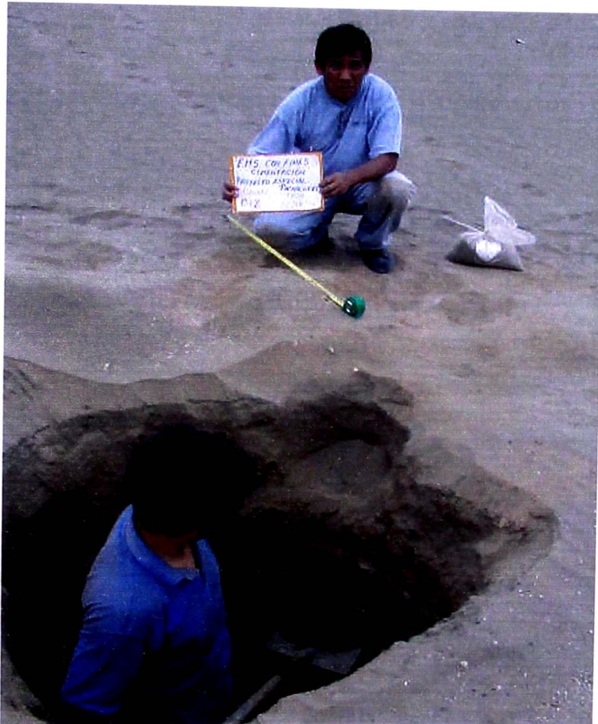
FOTO 3 perfil estratigráfico de la calicata C-2, a -1.00 m se tiene un suelo de características arena limosa en estado seco, no plástico, de baja compactación.
