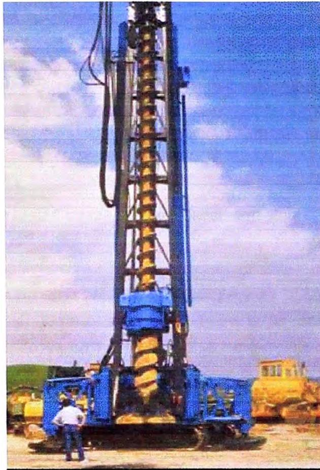
Fotografía III-5: Equipo con barrena continua.
