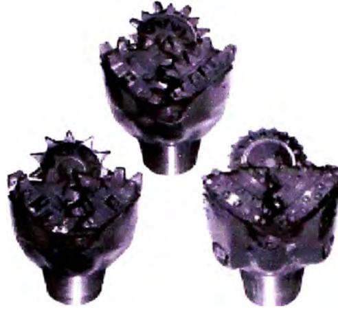
Figura III-2: Tipos de trépanos de perforación.
