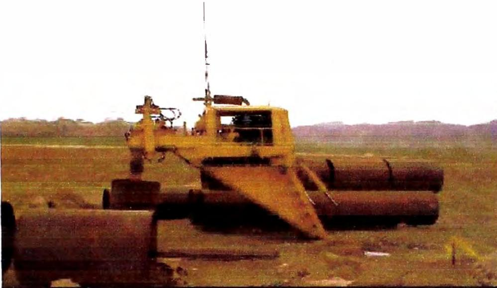
Fotografía III-1: Equipo de perforación por rotación.
