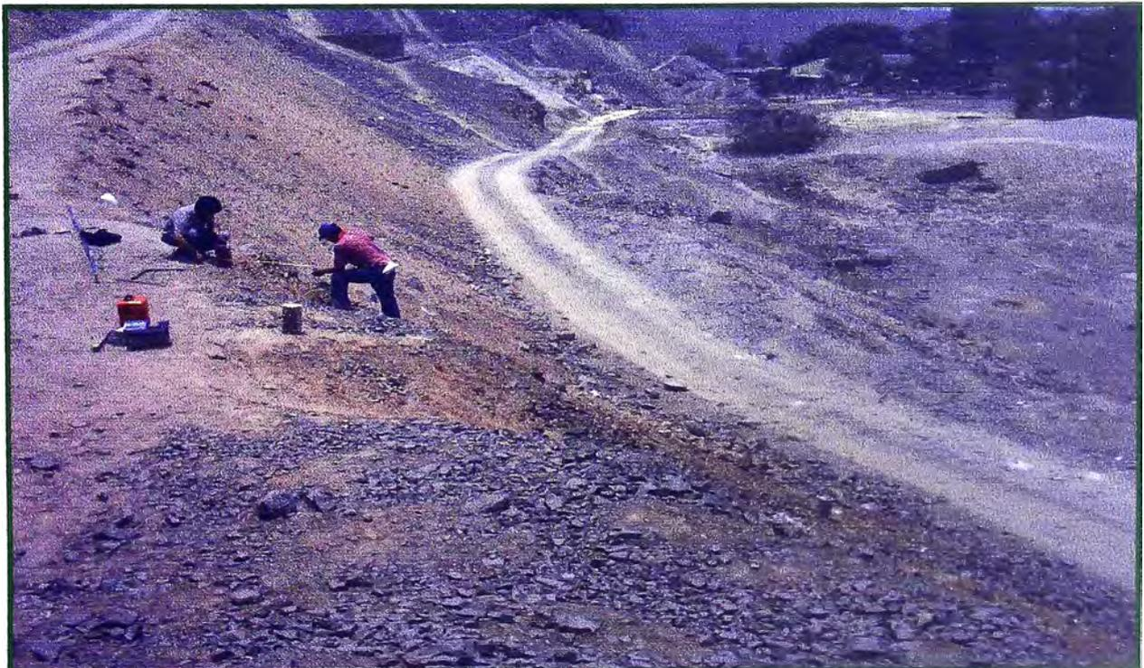
**Fotografía N° 03:** Muestreando el material, para su respectivos ensayos de suelos.
