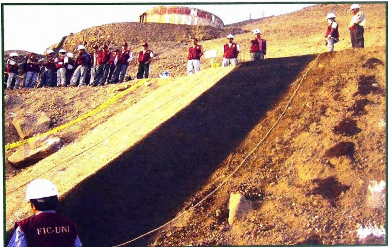
**Fotografía N° 07:** Distribución de los tres mantos de prueba, en nuestro sector donde se planteo el control de erosión de taludes con geosintéticos.
