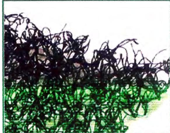
Figura N° 02 - Geomanta de fibra polipropileno
