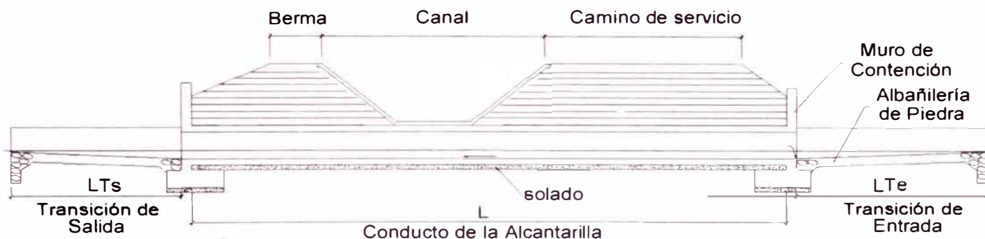
Figura No 3.5.1 Partes de la Alcantarilla
