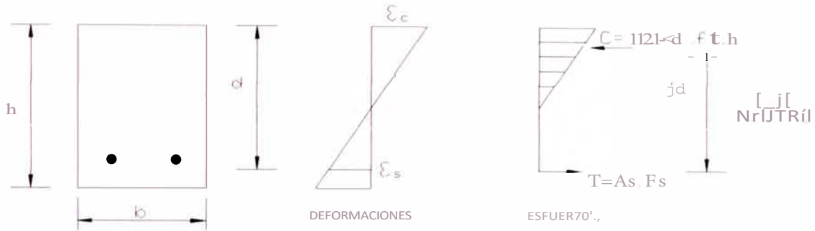
Figura N° 3.1.1 Diagrama de esfuerzos y deformaciones de una sección rectangular con esfuerzos en tensión sometida a flexión
