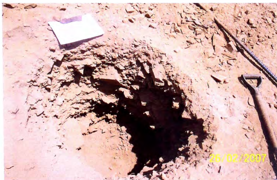
Foto N° 4 Exploración a Cielo Abierto. Calicata N° 2
