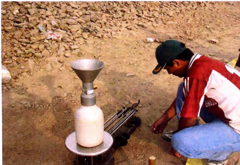
Foto N° 2 Evaluación Geotécnica Ensayo de densidad de Natural Cono de Arena
