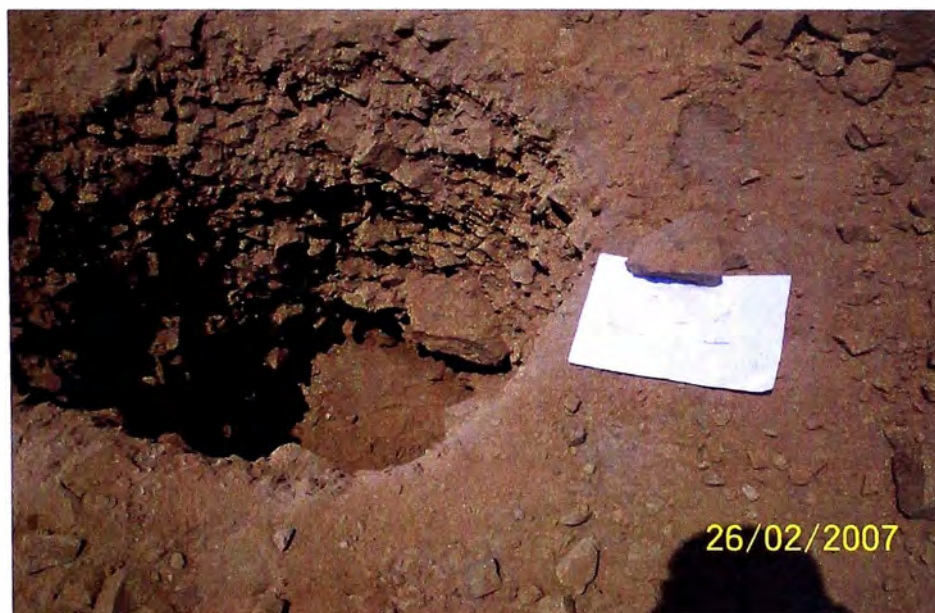
Foto N° 3 Exploración a Cielo Abierto. Calicata N° 1
