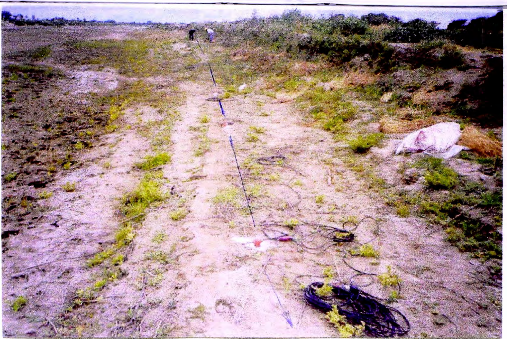
Foto N° 21: Línea sísmica ubicada aguas arriba del Puente Independencia ,
