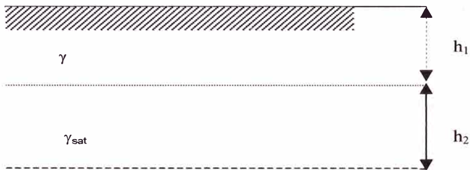
Figura Nº 06 tensiones en una masa de suelo cuando el nivel freático no está en la superficie
