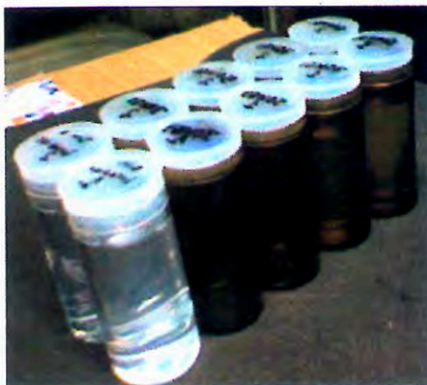
Figura 24. Muestras de coloides de ZnO sin irradiar e irradiados a 30 kGy, 50 kGy, 75 kGy, 100 kGy.
