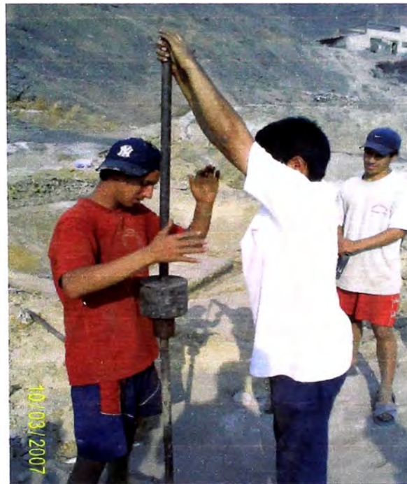
Imagen 2.5 Foto del ensayo DPL-03.
