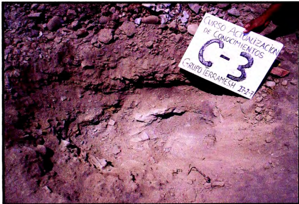
Foto N° 08: Estratigrafía de la Calicata C-3, se presenta roca ligeramente fracturada al fondo de la excavación.
