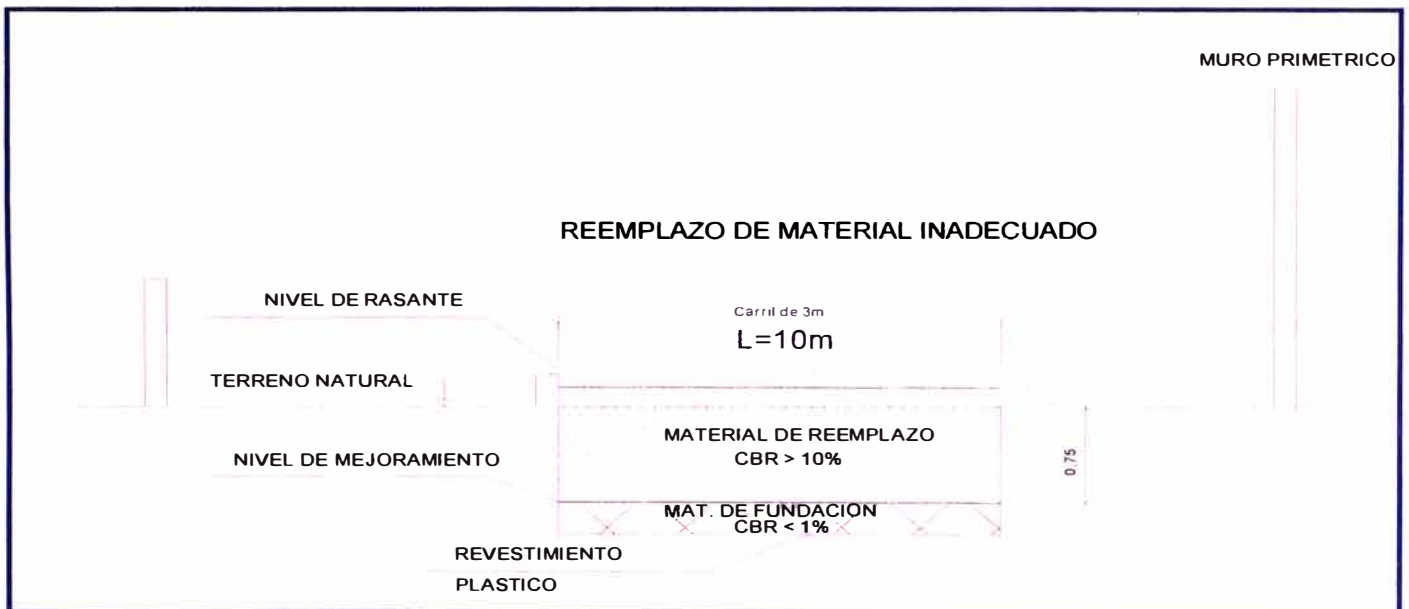
Fig. 1.2 : Gráfico del Diseño de Pavimento sin Refuerzo
