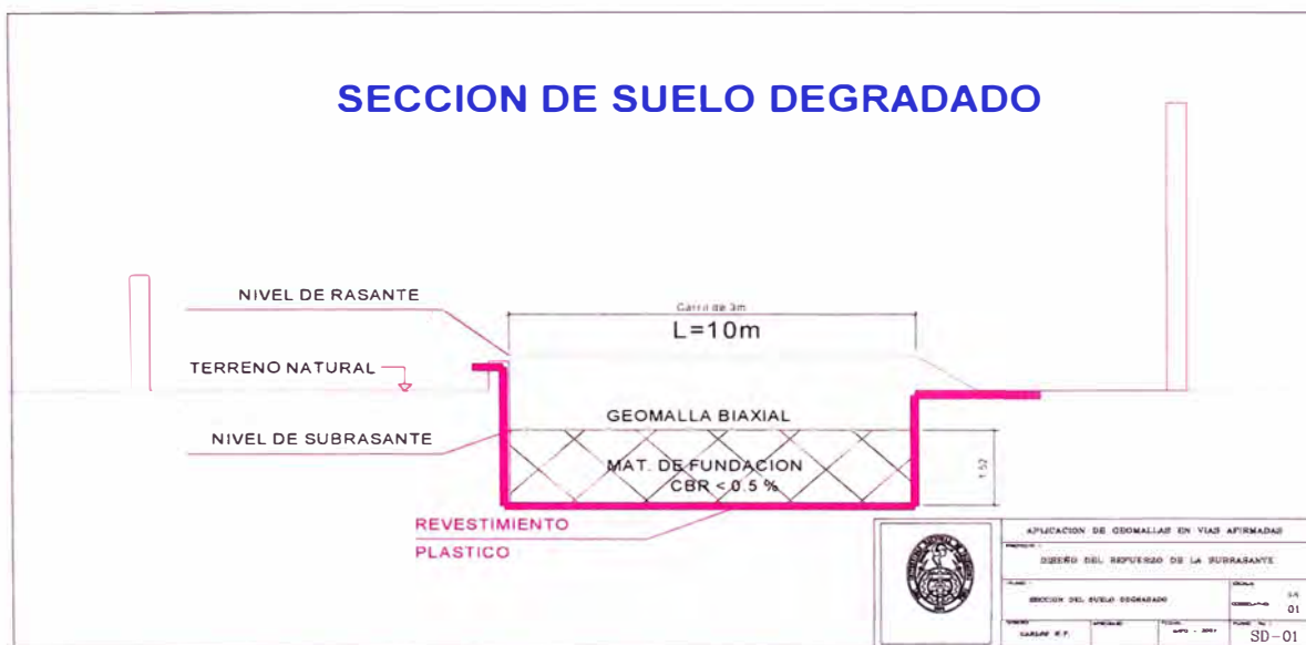
Figura 0.2 – Sección de suelo degradado
