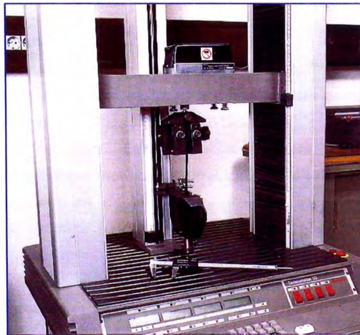
Fig. 1.6 – Ensayo de tracción en nodos
