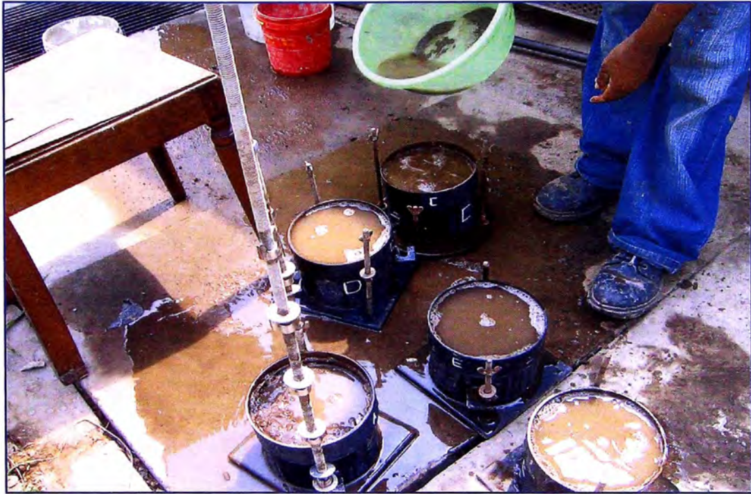
Figura 4.9: Material sometido a compactación en gabinete y saturación al 100% para ensayarse con el DPL
