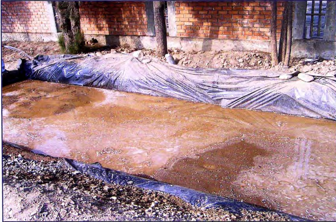
Figura 4.7: Saturación del material cernido para obtener un CBR < 1%
