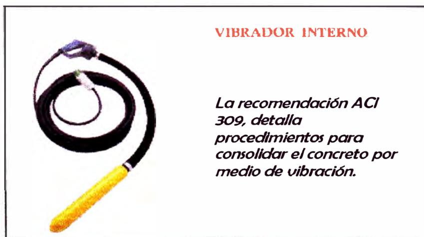
La vibración permite la colocación y consolidación del concreto con asentamiento de 2" a 4" en elementos altamente reforzados, e inclusive de asentamientos mas bajos que en colocaciones abiertas.
