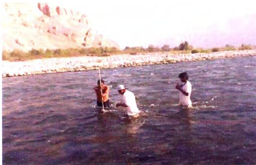
Fig. 4.2. Medición de valores puntuales a 12m de la orilla
