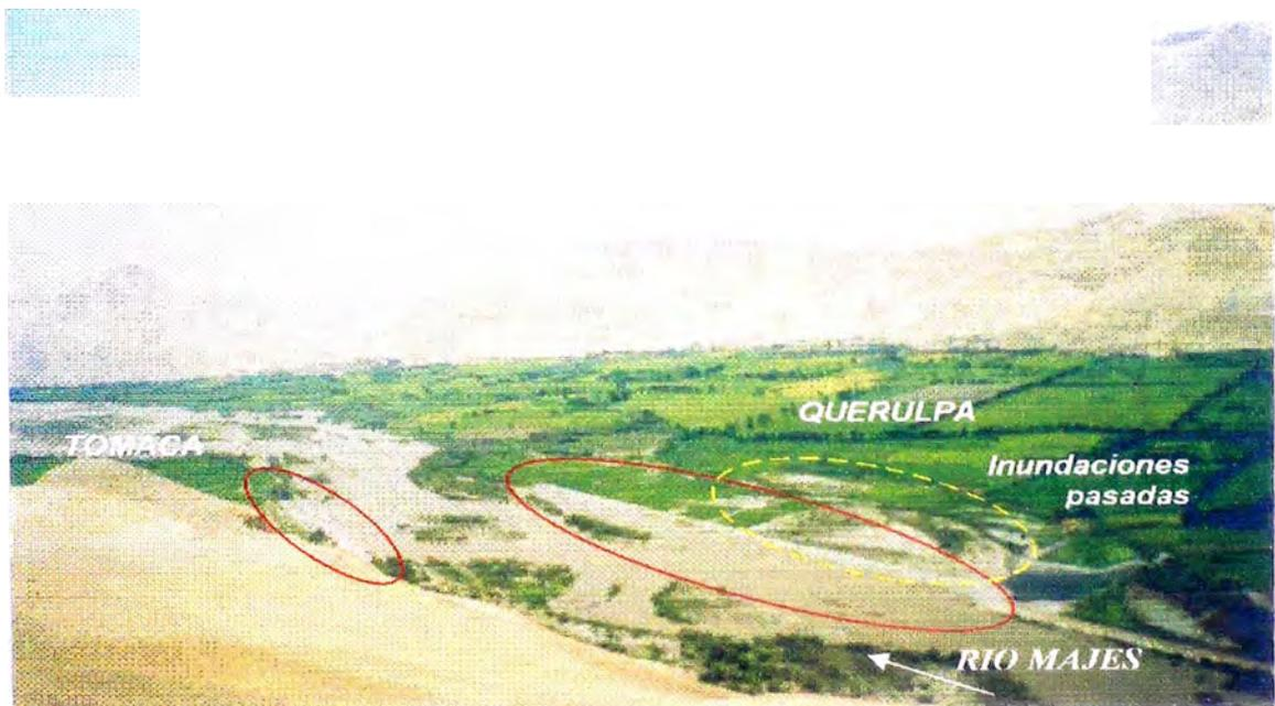
*Fig. 2.5. Rastros de Inundaciones pasadas, 13 espigones sector Querulpa y 3 espigones sector Tomaca – Vista panorámica, margen izquierda aguas abajo.*
