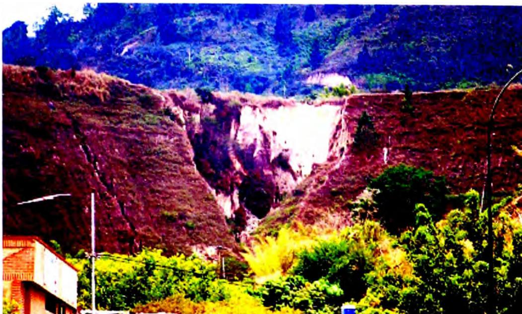
Imagen N° 1.03: Deslizamiento por falla interna – Imagen publicada en el II Simposio Internacional de Geotecnia y Medio Ambiente (2)
