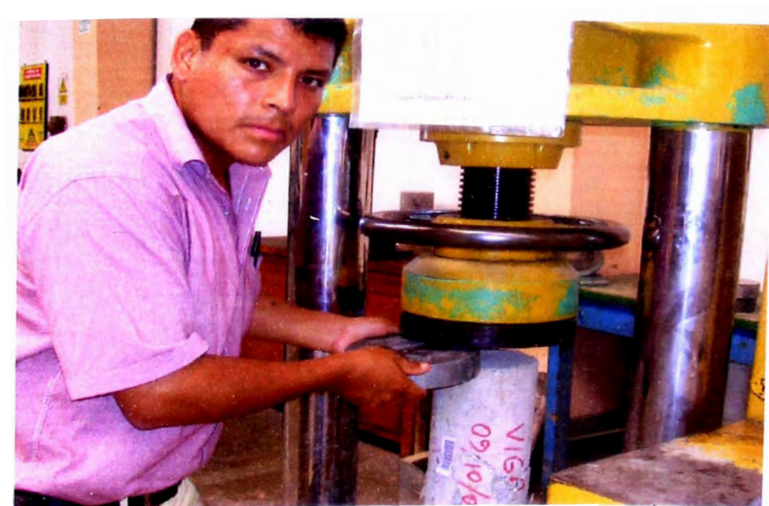
FOTO Nº 18.- FACILIDAD DE USO DE LAS ALMOHADILLAS. COLOCACIÓN DEL PLATO RETENEDOR SOBRE LA PROBETA.
