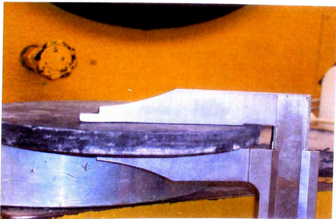
FOTO Nº 16.- ALMOHADILLA DE CAUCHO NEOPRENO DE 85 SHORE DE DUREZA DE ESPESOR E=13 MM.
