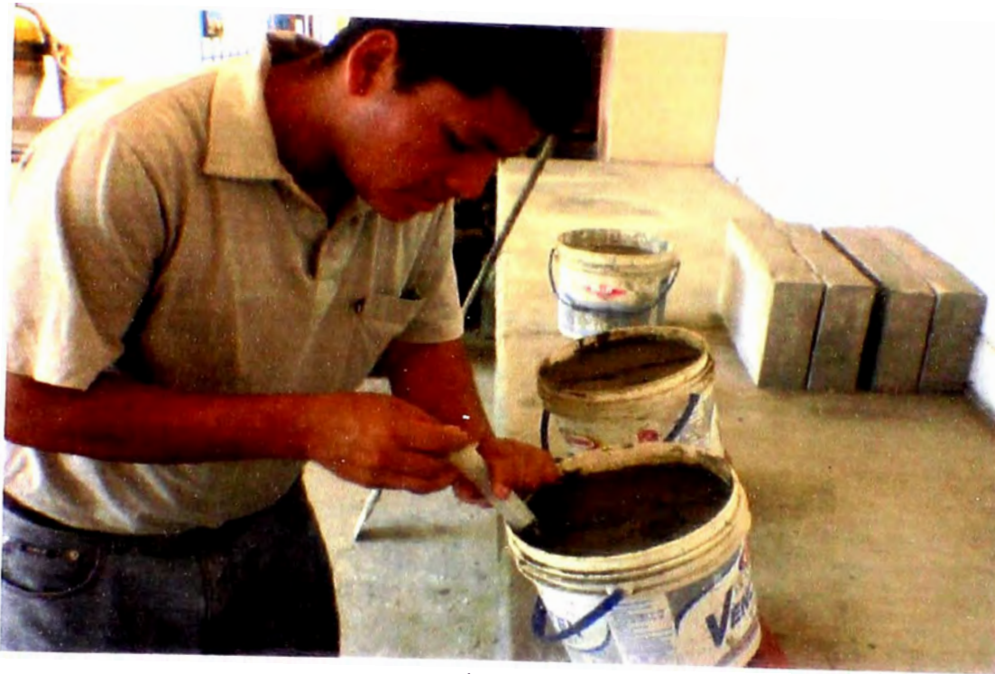
FOTO Nº 07.- ENSAYO DE EXUDACIÓN DEL CONCRETO.
