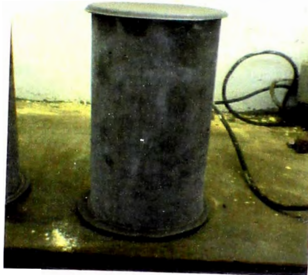
FOTO Nº 09.- PROBETA CAPEADA (AZUFRE Y BENTONITA).
