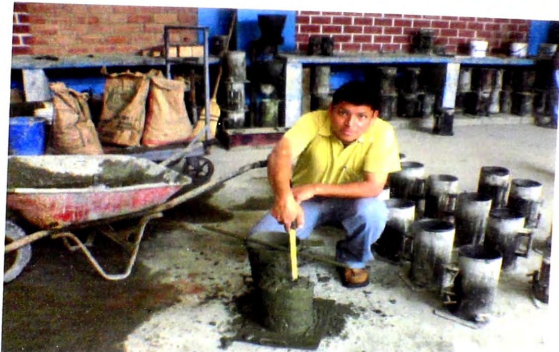
FOTO Nº 04.- ENSAYO DE CONSISTENCIA (SLUMP) DEL CONCRETO.
