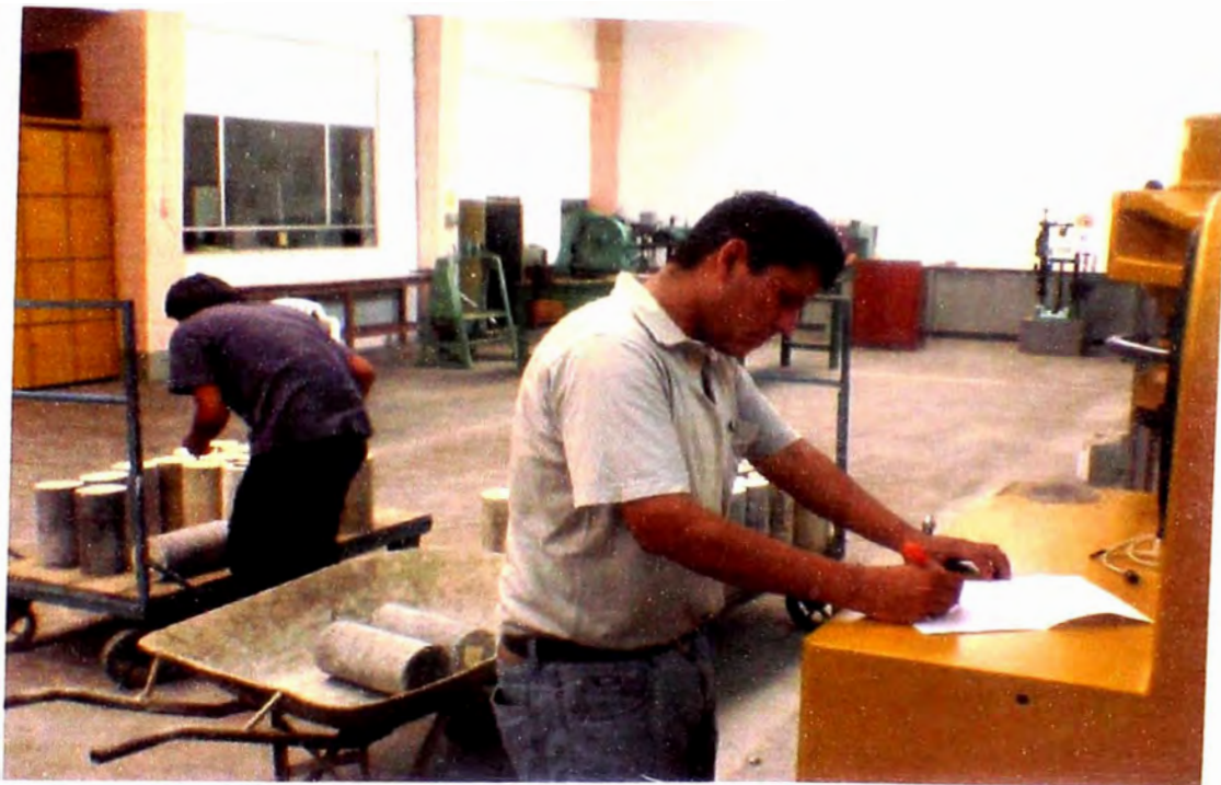
FOTO Nº 10.- ENSAYO DE COMPRESIÓN DE PROBETAS DE CONCRETO.
