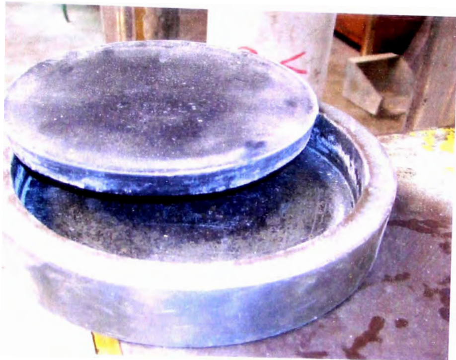
FOTO Nº 15.- PLATO RETENEDOR METALÍCO Y ALMOHADILLA DE CAUCHO NEOPRENO DE 85 SHORE DE DUREZA.
