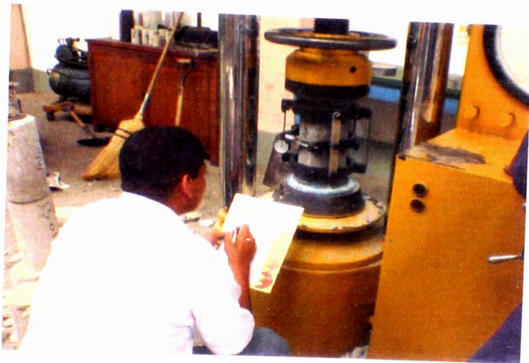
FOTO Nº 13.- ENSAYO DE MÓDULO DE ELASTICIDAD DEL CONCRETO.
