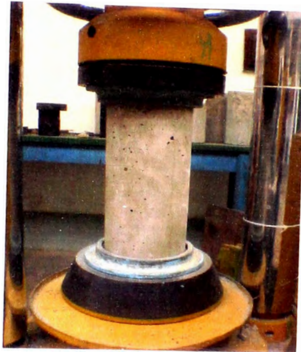
FOTO Nº 11.- ROTURA DE PROBETAS CON ALMOHADILLAS DE CAUCHO NACIONAL
