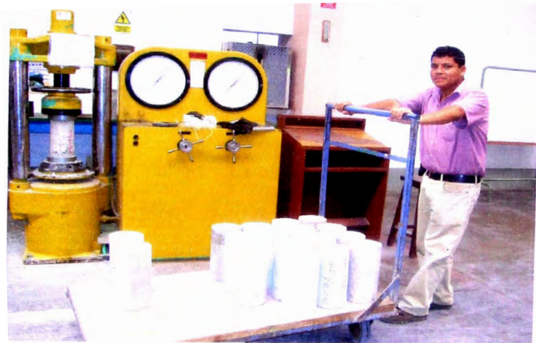
FOTO Nº 17.- ENSAYO DIRECTO DE LAS PROBETAS, SIN PERDIDA DE TIEMPO PARA EL CAPEADO.
