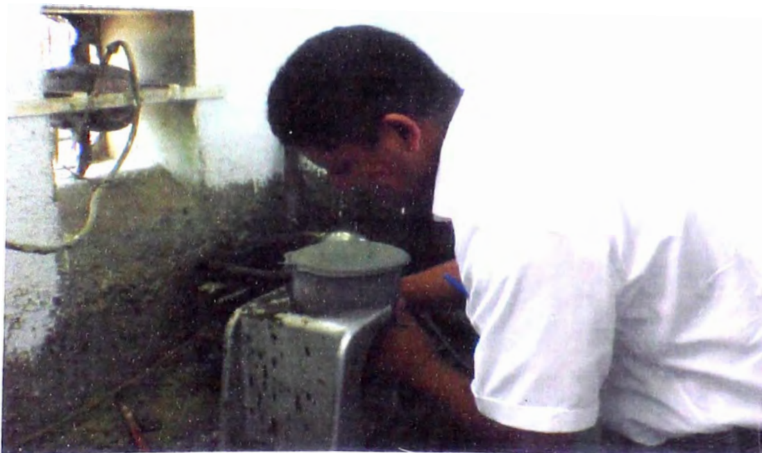
FOTO Nº 08.- CAPEADO DE LAS PROBETAS DE CONCRETO.
