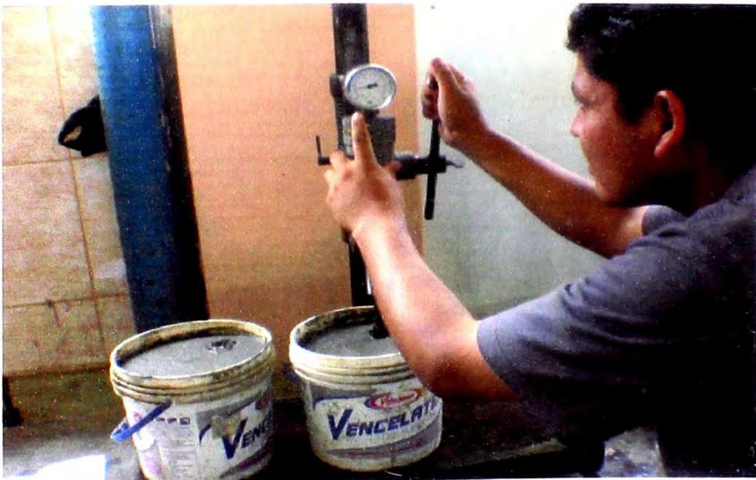
FOTO Nº 06.- ENSAYO DEL TIEMPO DE FRAGUADO DEL CONCRETO.
