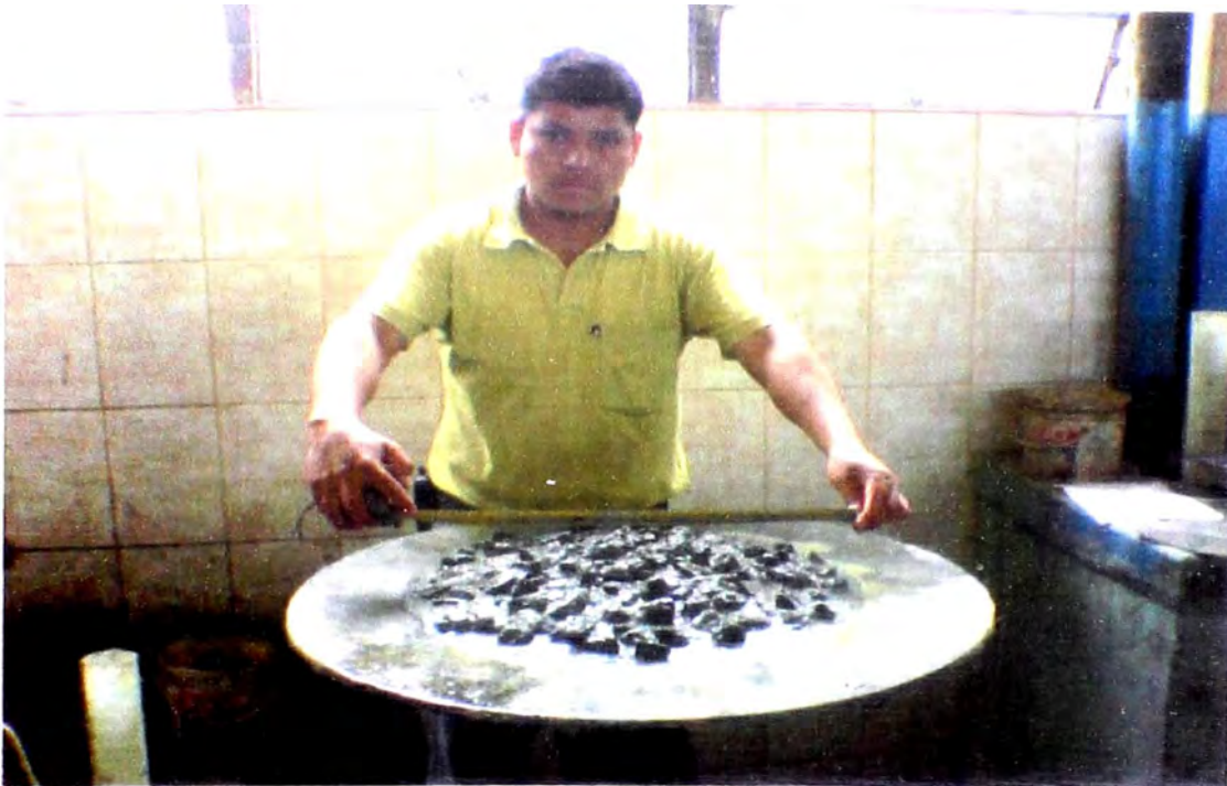
FOTO Nº 05.- ENSAYO DEL PORCENTAJE DE FLUIDEZ DEL CONCRETO.
