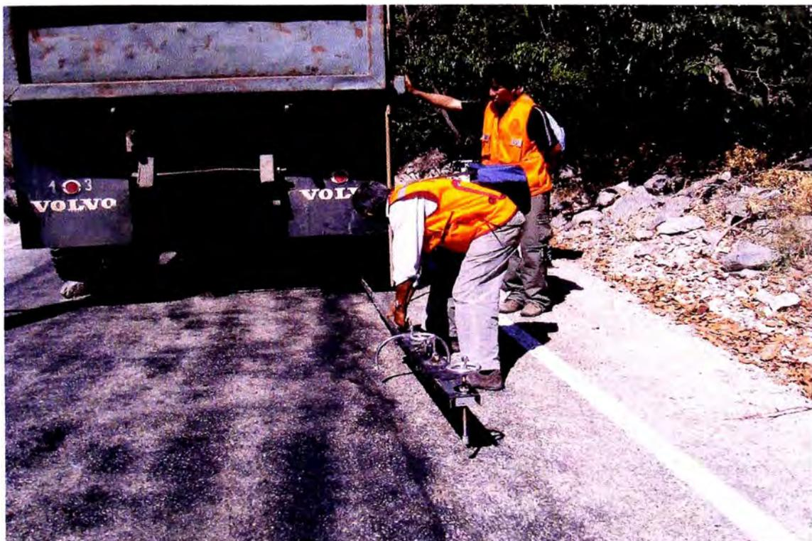
**Foto N°02: Posicionamiento de viga, por debajo de los ejes del camión cargado a 8.2 ton.**
