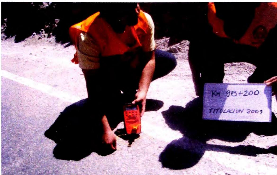
**Foto N°03: Medición de la temperatura a la superficie de rodadura**
