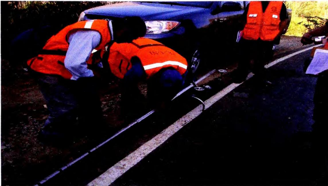
**Foto N°01: Preparación del equipo Viga Benkelman, para el inicio de las mediciones de deflexiones**
