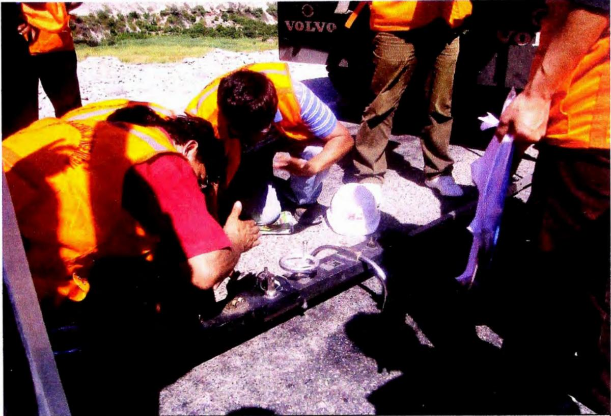
**Foto N°05: Recopilación de datos de deflexiones con Viga Benkelman.**
