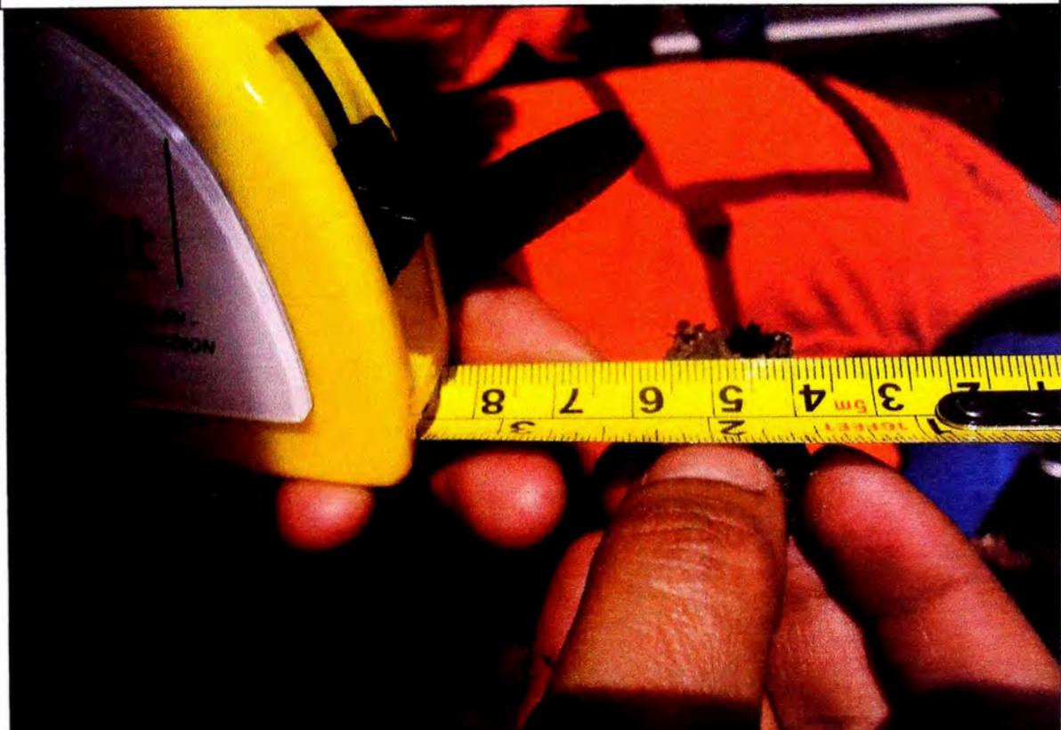
**Foto N°06: Recopilación de espesor de la carpeta de rodadura.**
