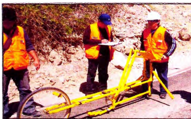
Fotografía 2.1 Uso del equipo MERLIN para el tramo de prueba
