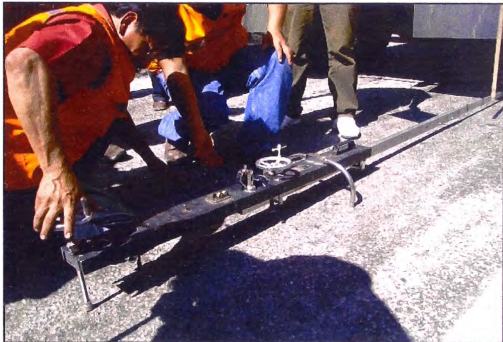
Foto 3: Calibración de la Viga Benkelman en el punto de ensayo, previo a realizar las mediciones de deflexiones.
