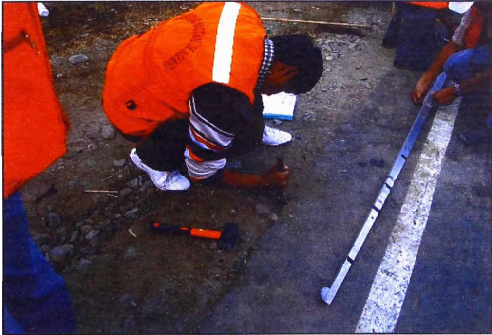
Foto 7: Extracción de una muestra de la carpeta de rodadura, con comba y cincel para medir su espesor.
