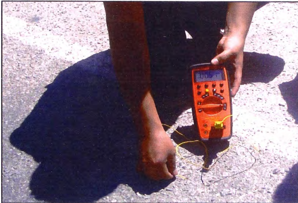
Foto 5: Medición de la temperatura de la carpeta de rodadura en el punto de ensayo, con termómetro digital.
