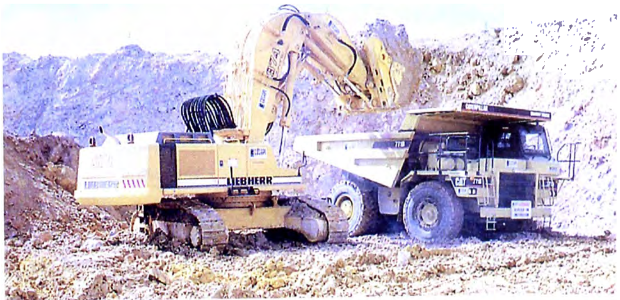
Figura 3.2.4.1.- Excavadora Liebherr 974 cargando mineral a camión cantera CAT 771D
