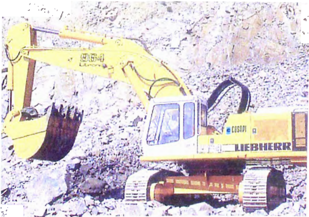
Equipos adquiridos por COSAPI para la Operación de Sipán: Excavador Liebherr 964
