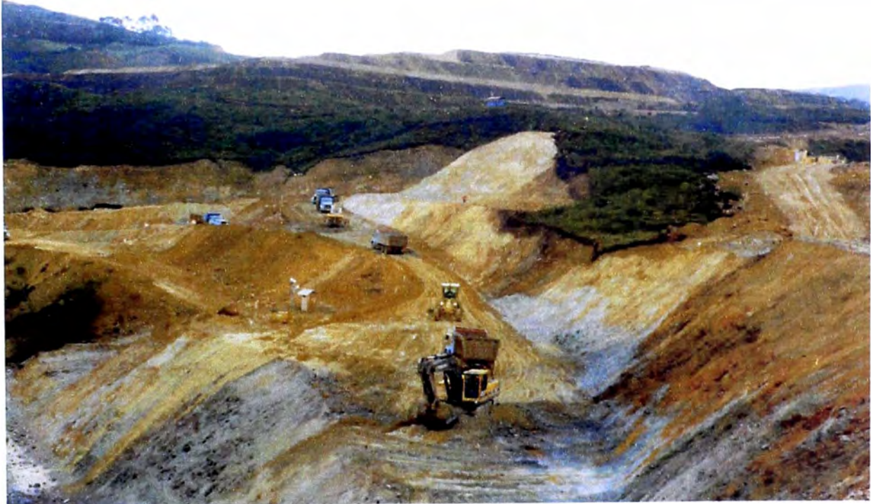
Figura 3.2.5 1 y 2.- Vista de transporte de desmote y camión CAT 771D descargando
