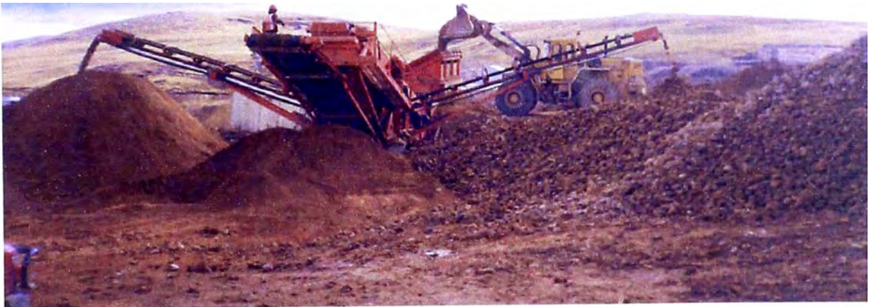
Figura 3.1.10-2.- Chancadora BARBER GREEN produciendo PDL.
