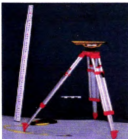
Figura 3.3. Nivel y mira topográfica
