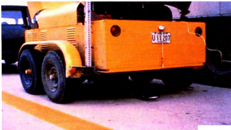
Figura 2.4: Equipo Deflectómetro Dinámico de Balanceo.
