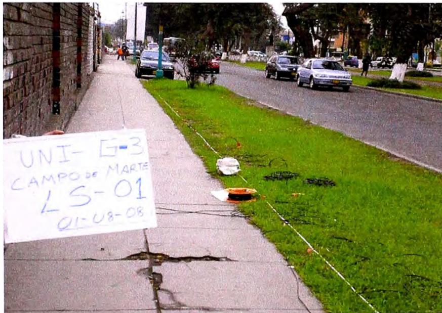
Foto 06: Vista panorámica en la que se observa el tendido de la Línea Sísmica LS-1. Ensayo de Refracción Sísmica.
