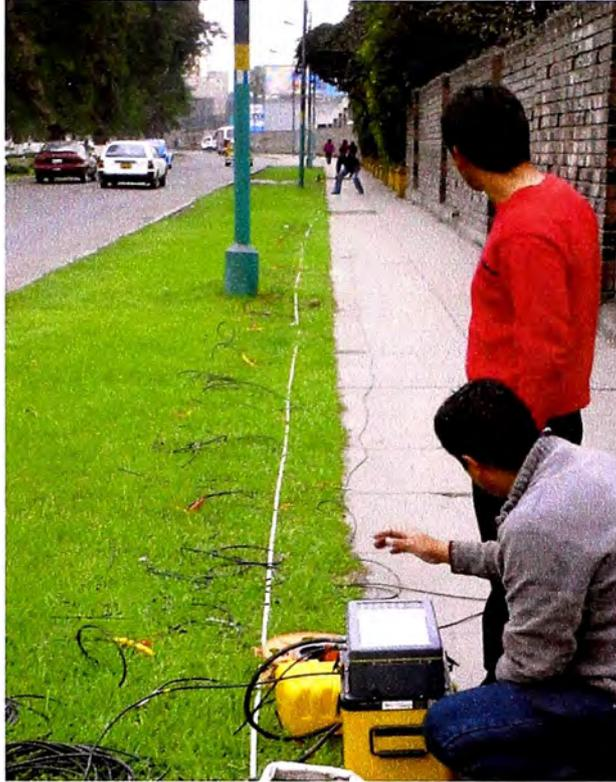
Foto 07: Vista panorámica en la que se observa el momento de adquisición de datos en el ensayo de Refracción Sísmica.
