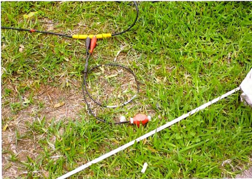
Foto 10: Vista en la que se observa uno de los 24 geófonos empelados en el ensayo.
