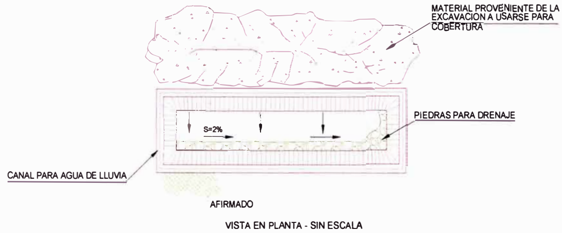
FIGURA N° 1 DETALLE DE MICRORELLENO SANITARIO MANUAL
