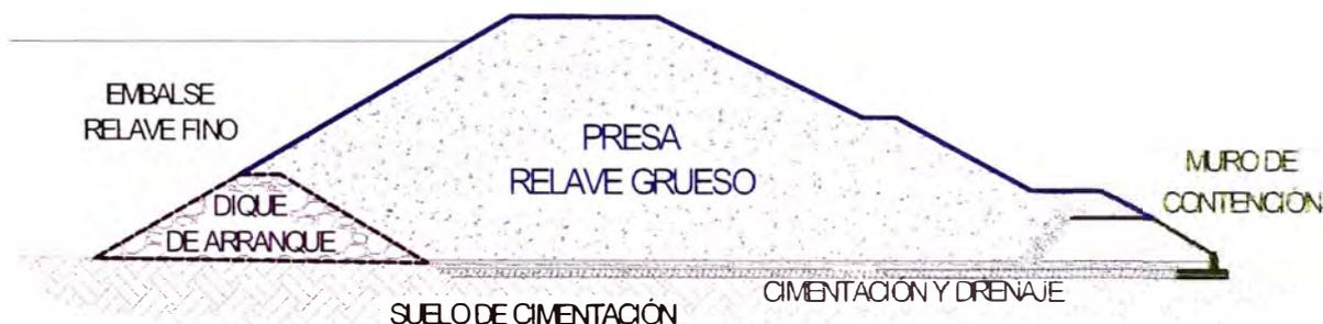
Fig 1.3. Elementos de la estructura de retención
