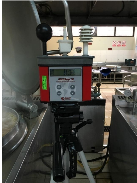
Foto 2. Equipo medidor de estrés térmico
