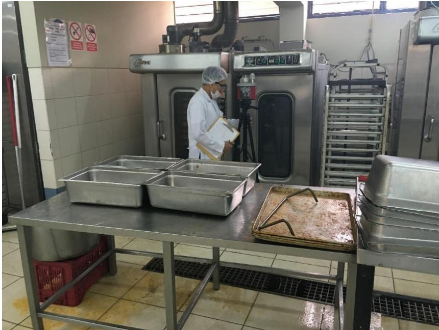
Foto 14. Medición de estrés térmico en zona del horno
