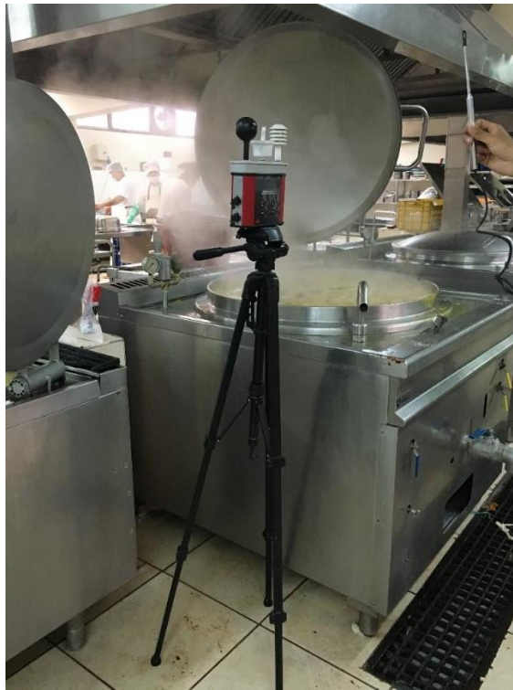
Foto 26. Medición de estrés térmico en zona de preparado de sopa
