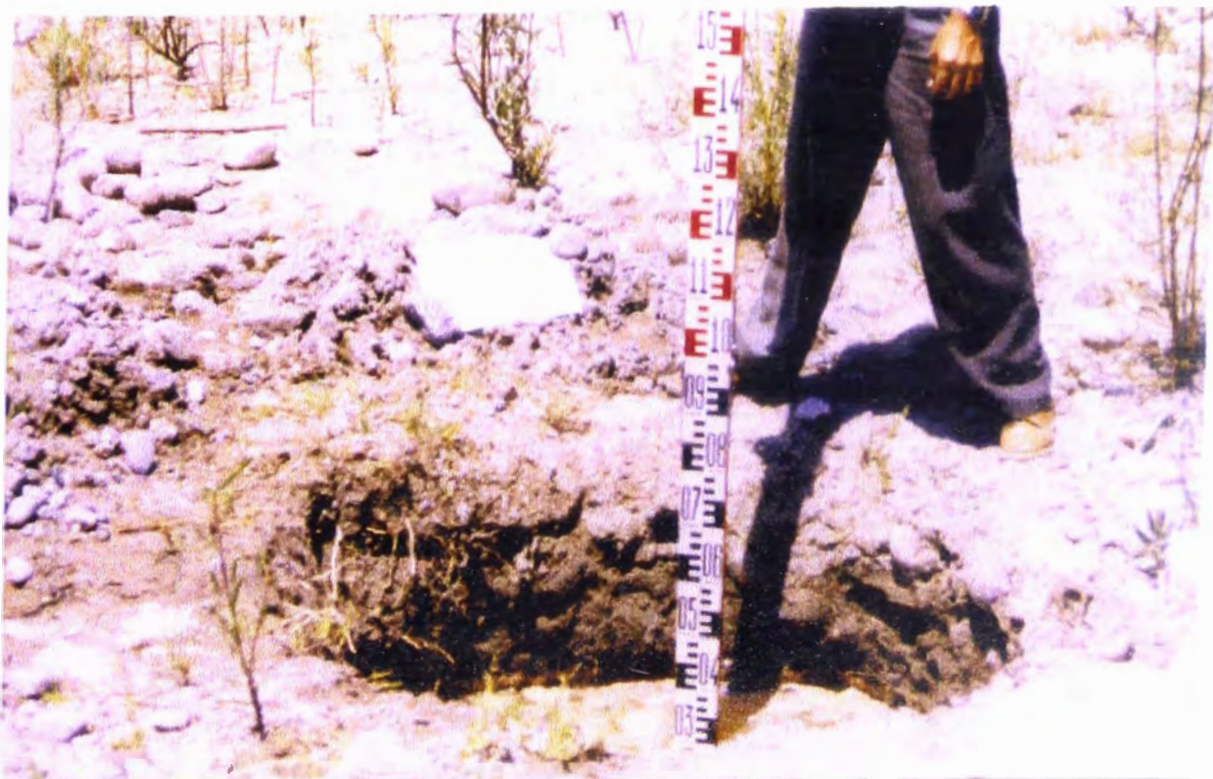
CALICATA NO. 3: VERIFICACION DE LA HUMEDAD DEL SUELO Y PRESENCIA DE VEGETACION
