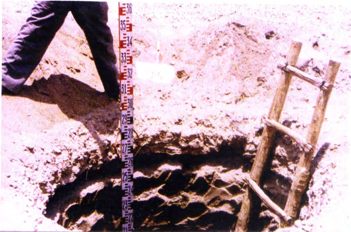
CALICATA NO. 8: VISTA DE LA MEDICION DE LA PROFUNDIDAD DE LA CALICATA, RESENCIA DE ABUNDANTE ARCILLA Y ESCASA VEGETACION
