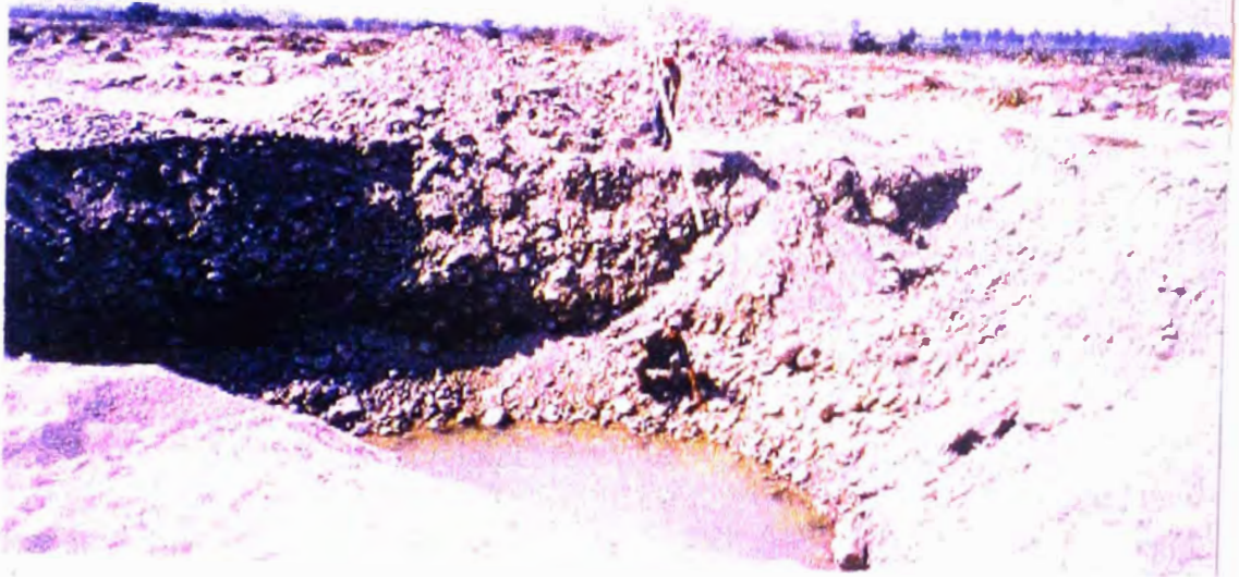
Controles Periódicos del Nivel Estático del Acuífero en las Calicatas de Estudio. Zona "A"
