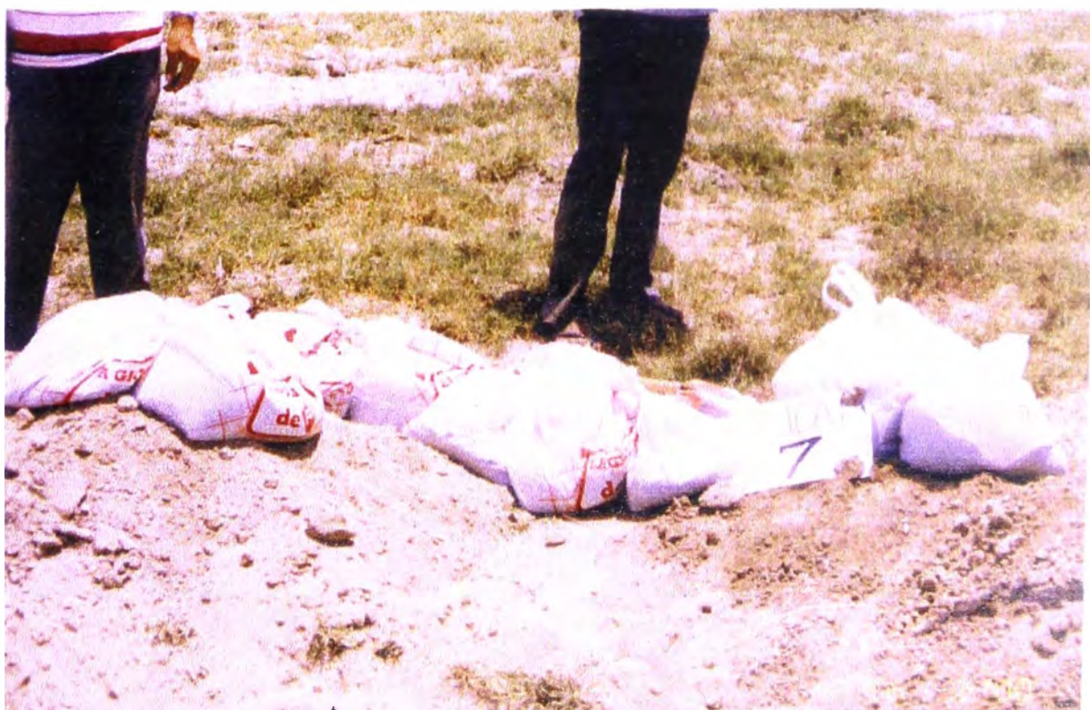
CALICATA NO. 7 : MUESTRAS OBTENIDAS DEL SUELO ARENO-LIMOSO.
