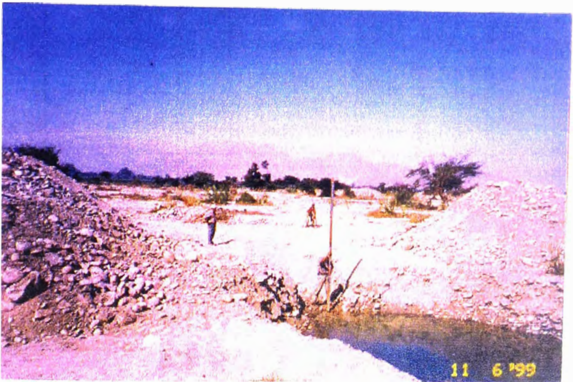
Controles Periódicos del Nivel Estático del Acuífero en las Calicatas de Estudio Zona "C"
