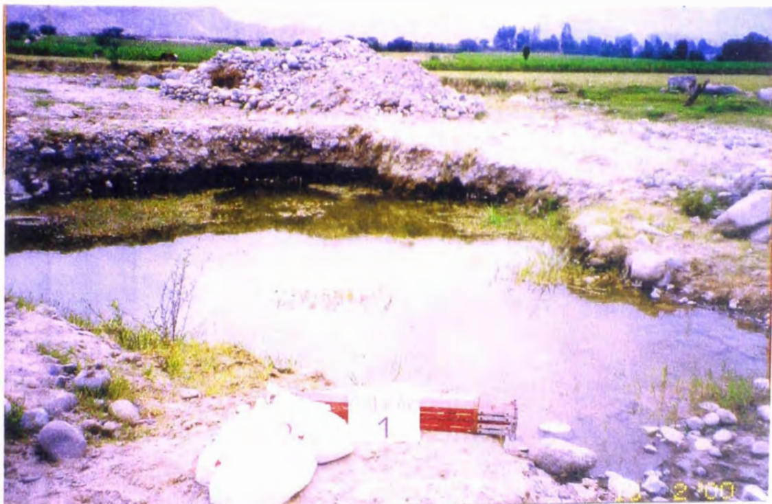
CALICATA NO.1 SE APRECIA LAS MUESTRAS OBTENIDAS, EL NIVEL ESTATICO DEL AGUA Y PRESENCIA DE CANTOS RODADOS ARENA.
