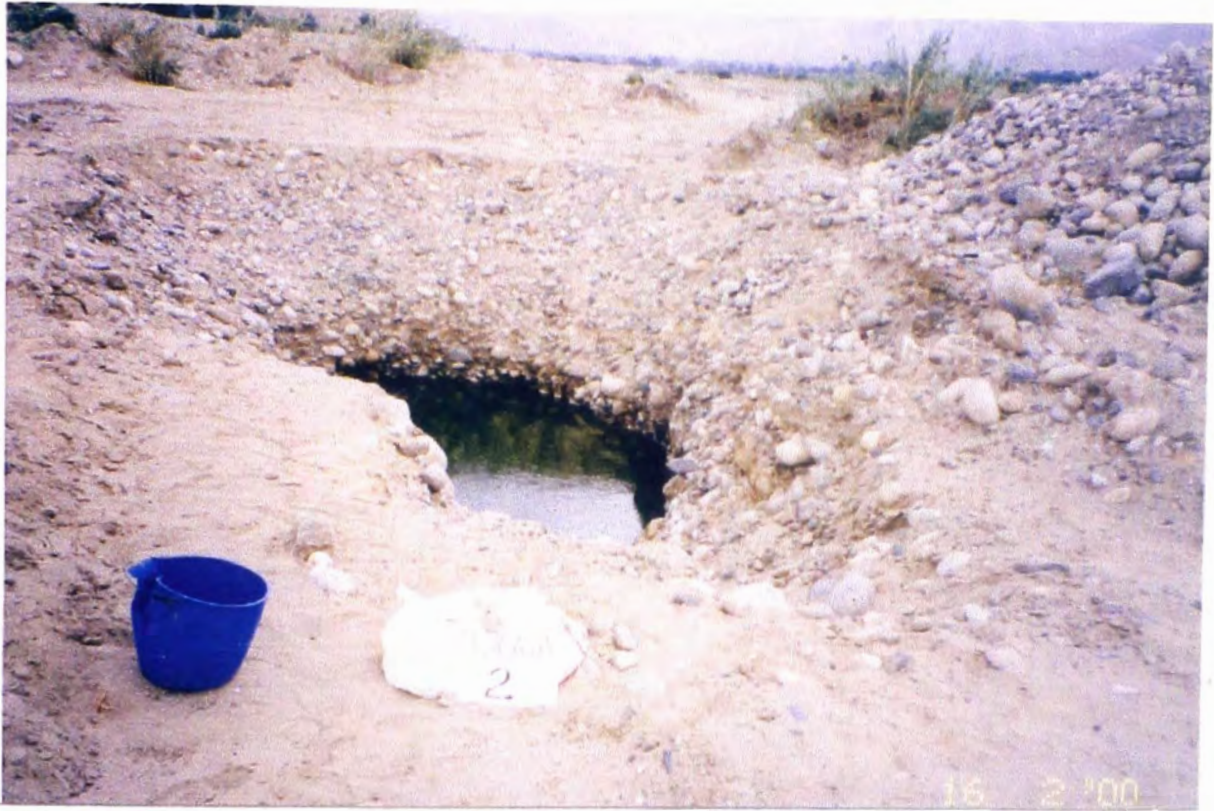
CALICATA NO. 2 : SE APRECIA NIVEL ESTATICO DEL AGUA, MUESTRA OBTENIDA Y ABUNDANTE PRESENCIA DE ARENA Y CANTOS RODADOS
