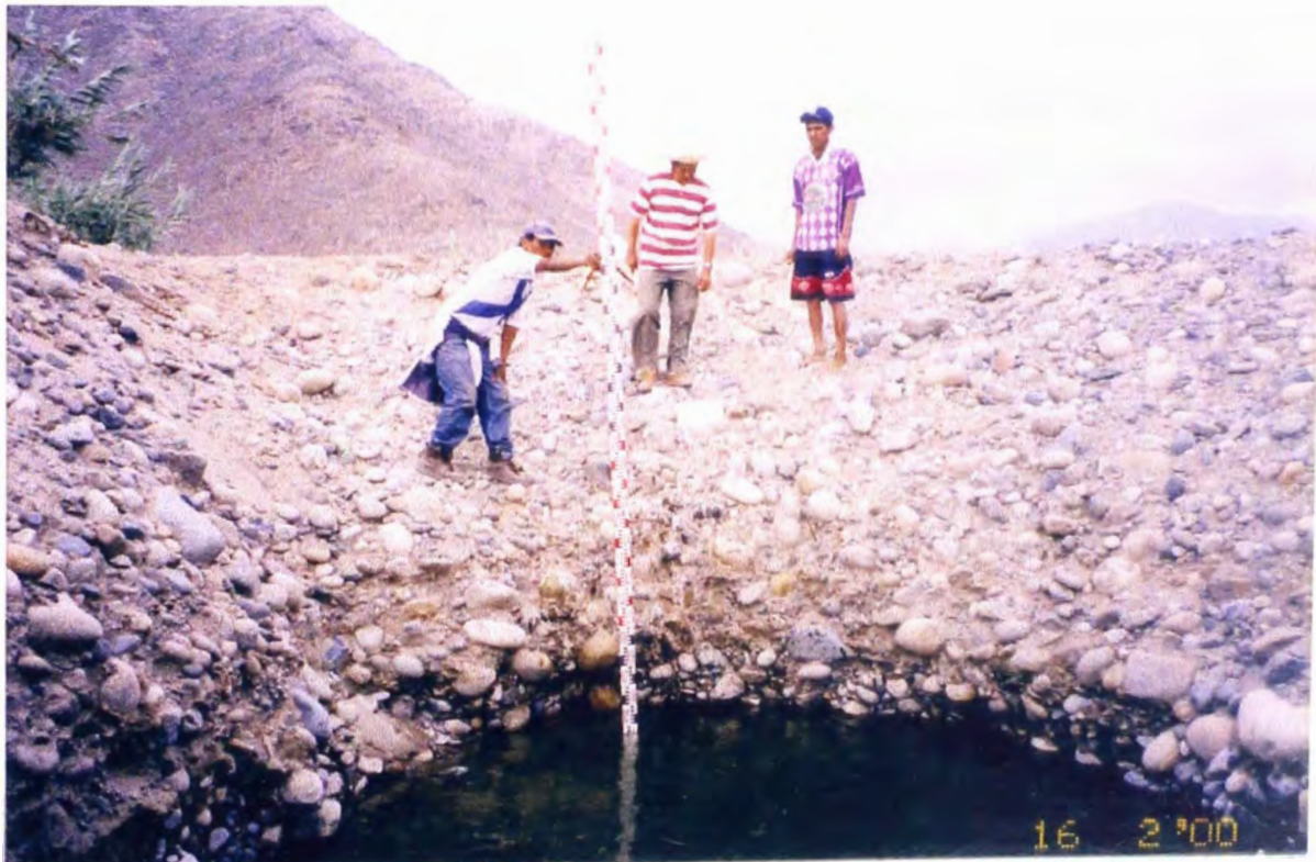
CALICATA NO. 2 : SE PUEDE APRECIAR LA MEDICION DE LA PROFUNDIDAD DE LA CALICATA Y EL NIVEL DE ESTATICO DEL AGUA
