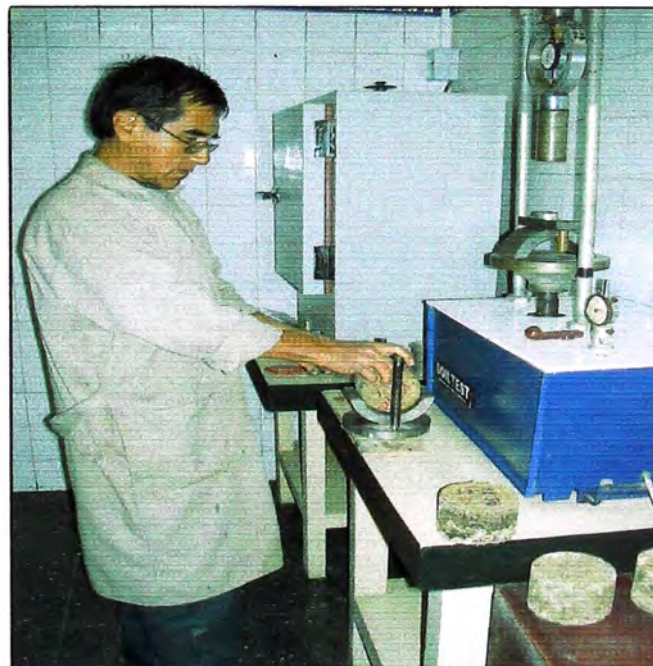
Figura N° 3.03 Ensayos estabilidad Marshall de muestras estabilizadas
