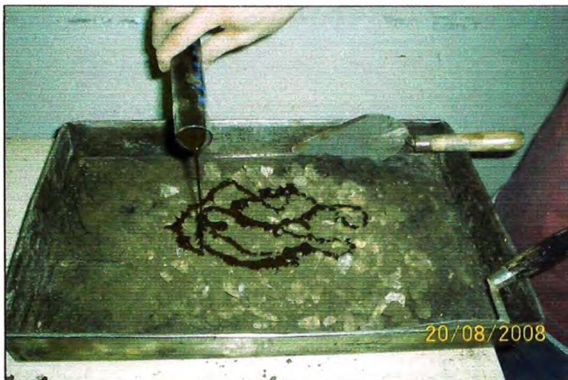
Figura N° 3.02 Batido de la emulsión con el material Fuente: Consorcio Gestión de Carreteras
