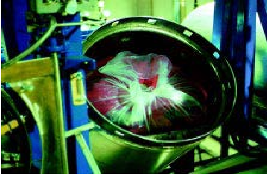
Figura N ° 2.9.2 Esterilizador a vapor para residuos sólidos de establecimientos de salud
