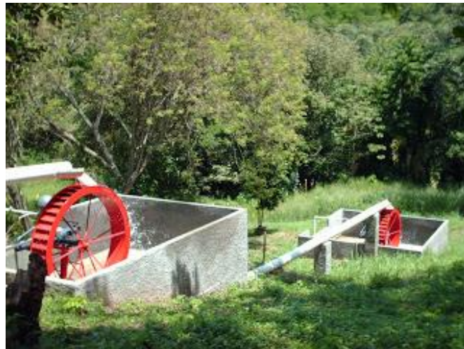
Figura N° 5. Microgeneración eléctrica con rueda hidráulica para proveer energía al sistema de riego tecnificado
