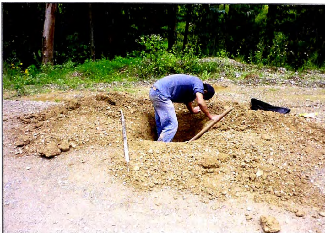
Foto N° 5 Calicata C-1 compuesto de gravas angulosas, lado derecha de la carretera, Km. 166+280, Alis (foto J. Centeno).
