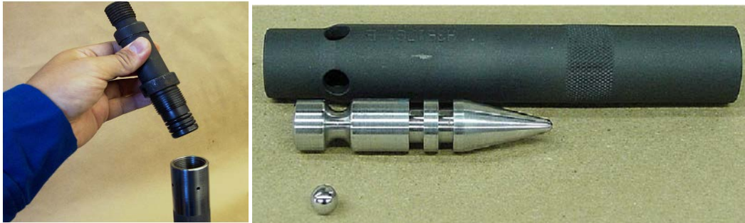
Figura 2.51. A la izquierda se observa cómo se ubica el adaptador con la camisa superior y a la derecha se observa el retenedor de bolas, el pin de detonación y las bolas de acero.
