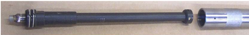
Figura 2.52. Ensamble superior que consta del material permeable ( ORIFICE ), pistón del material permeable, la varilla que mueve el pistón y la camisa superior.
