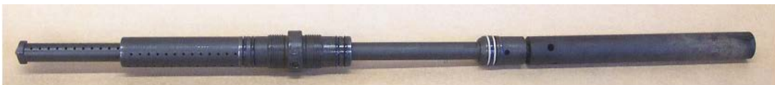
Figura 2.53. Ensamble de las varillas de seguridad que consta de la varilla con agujeros, la unión de las camisas, el pistón de las varillas con agujeros y la camisa retenedora de las bolas.
