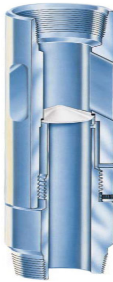
Figura 2.64. El sub y la cerámica cónica.
