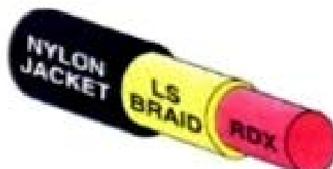
Figura 2.74. Distribución del explosivo en el cordón detonante.
