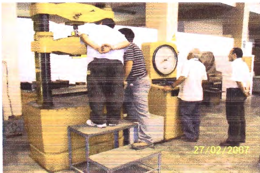
Foto 4.6. Ensayo de tracción
