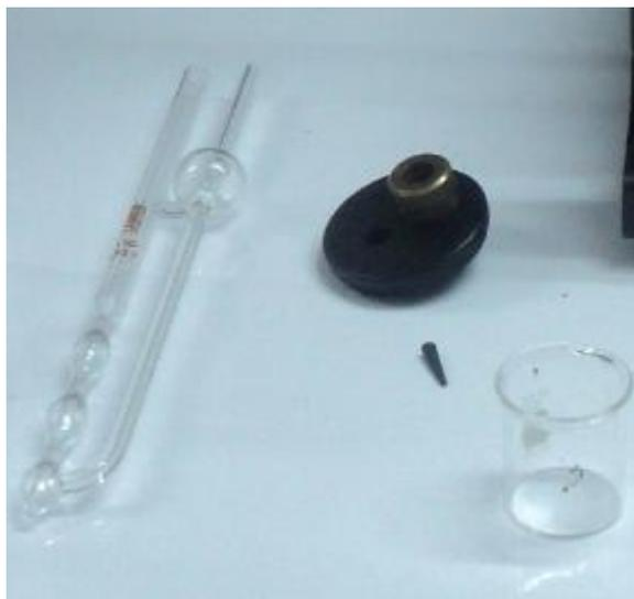
**Figura 4-16 Instrumentos para la Viscosidad Cinemática ASTM D445**
