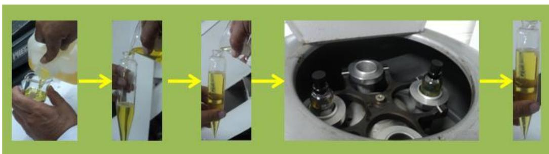
**Figura 4-33 Procedimiento para determinar el contenido de agua y sedimentos, Método ASTM D 1796**
