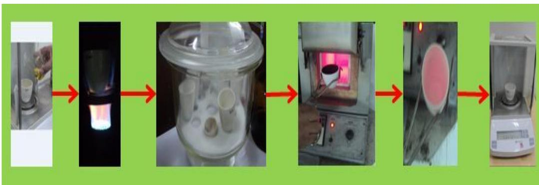
**Figura 4-21 Procedimiento para determinación de cenizas ASTM D482**
