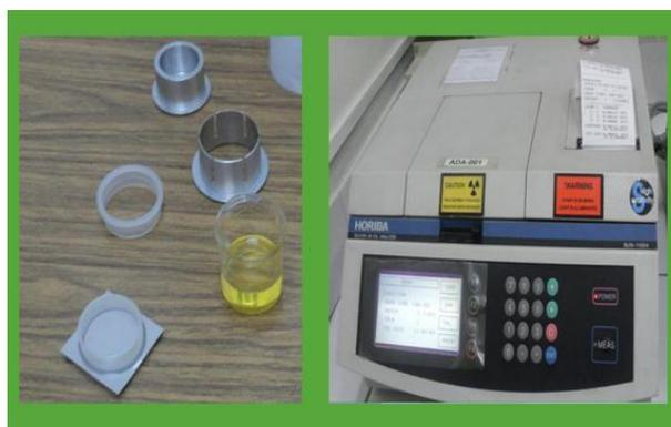
**Figura 4-28 Instrumentos para determinar el contenido de azufre**
