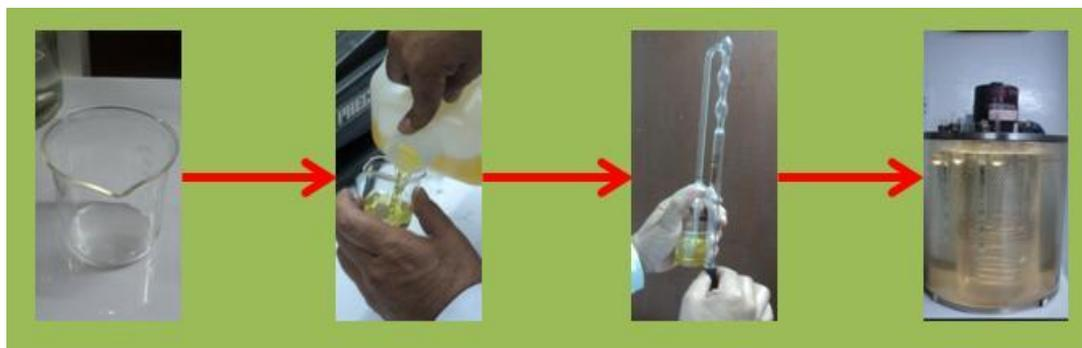
**Figura 4-17 Procedimiento para la Viscosidad Cinemática ASTM D 445**
