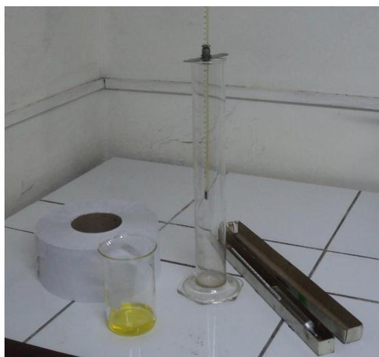
**Figura 4-1 Equipos para determinación de la Densidad ASTM D1298**
