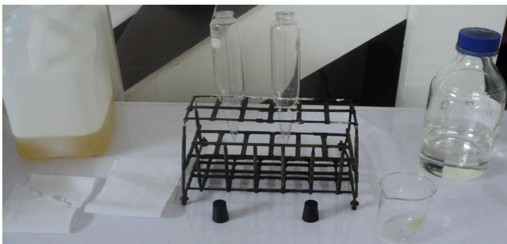
**Figura 4-32 Instrumentos para determinar el contenido de agua y sedimentos, Método ASTM D 1796**
