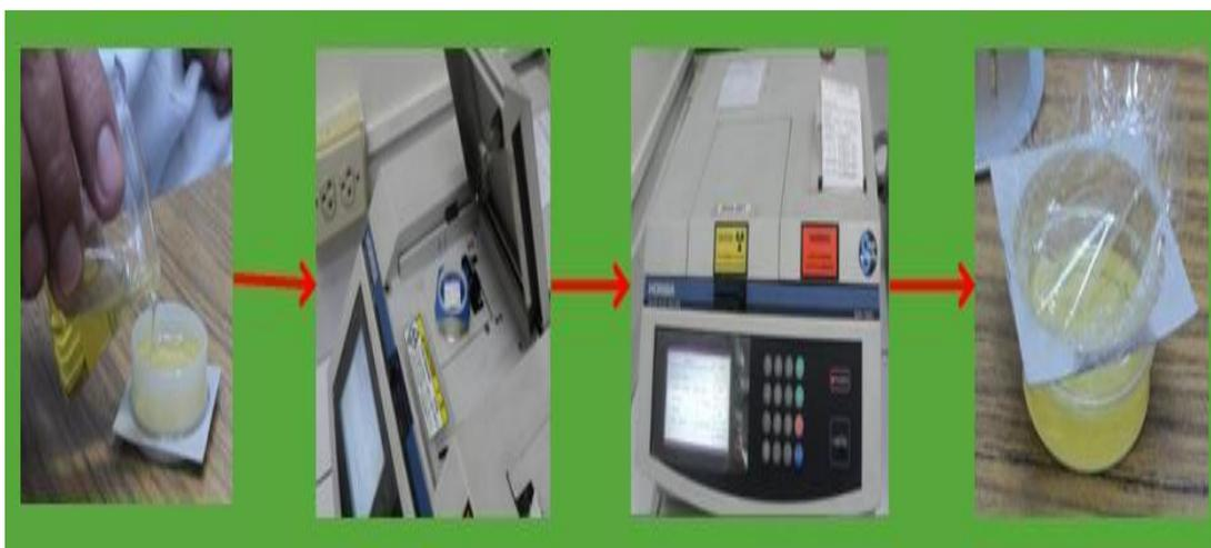
**Figura 4-29 Procedimiento para determinar el contenido de Azufre**
