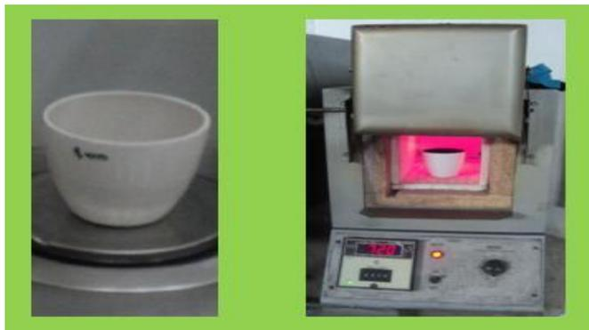
**Figura 4-20 Equipo para determinación de Cenizas ASTM D 482**
