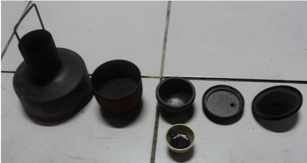
**Figura 4-24 Instrumentos para la determinación de Carbón Conradson**
