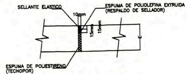
DETALLE DE JUNTA
