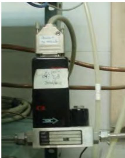
Figura 2.29. Medidor/controlador de flujo másico de los gases
