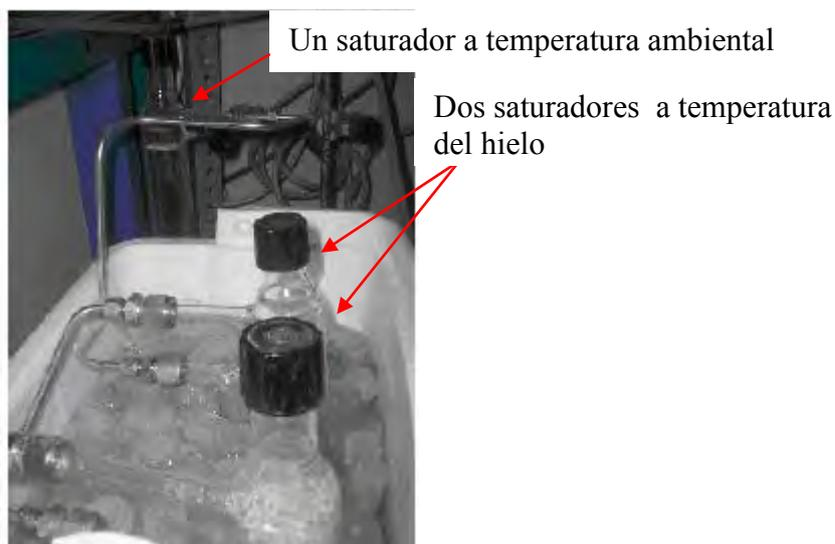
*Figura 2.34. Batería de saturadores usadas en el experimento*
