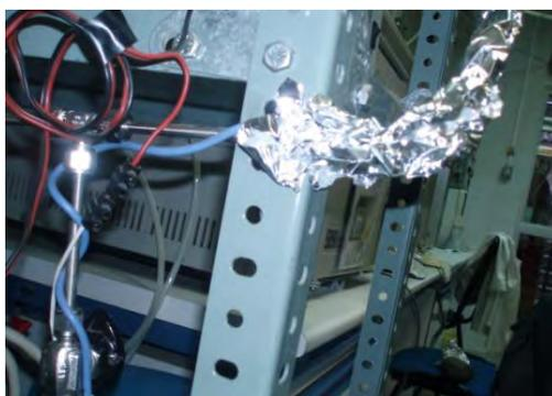
Figura 2.33. Mantas Calefactoras usadas en las tuberías del sistema experimental
