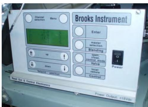
Figura 2.30. Caja de control de los medidores de flujo másico de alimentación
