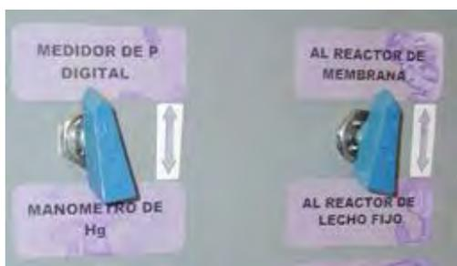
Figura 2.31. Válvulas de tres vías para controlar el flujo de gases
