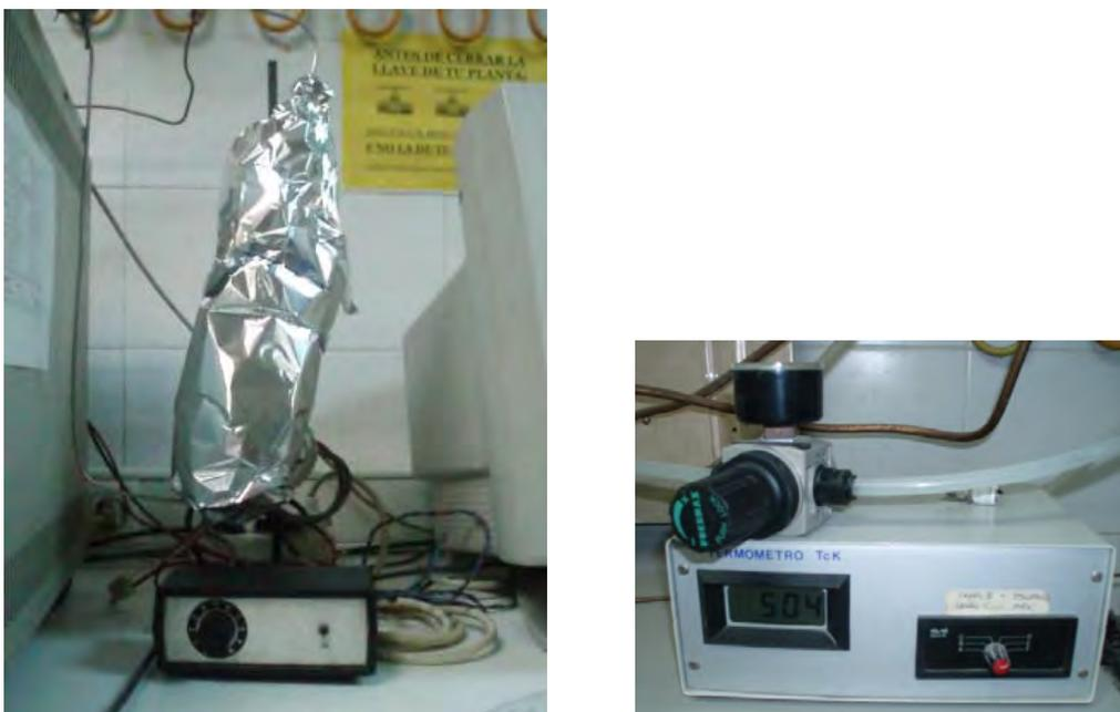
Figura 2.37. (a) Metanizador. (b) Medidor de temperatura del metanizador
