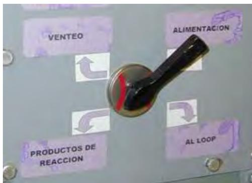
Figura 2.32. Válvula de cuatro vías
