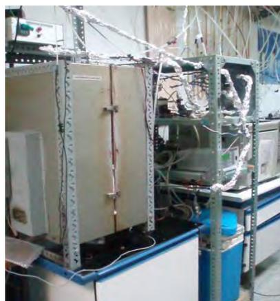
*Figura 2.28. Sistema experimental para combustión de n-hexano en un reactor de lecho fijo.*
