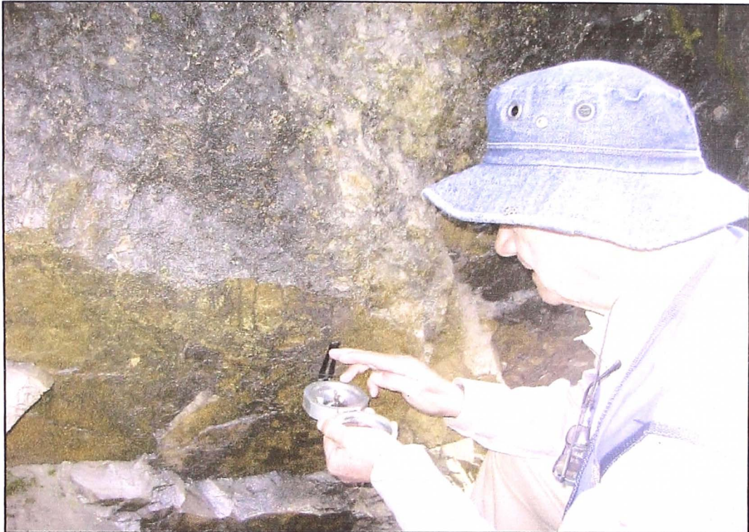
Foto N° 11: Toma de buzamientos en el afloramiento rocoso comprendido entre las progresivas Km. 165+485 y Km. 165+510.
